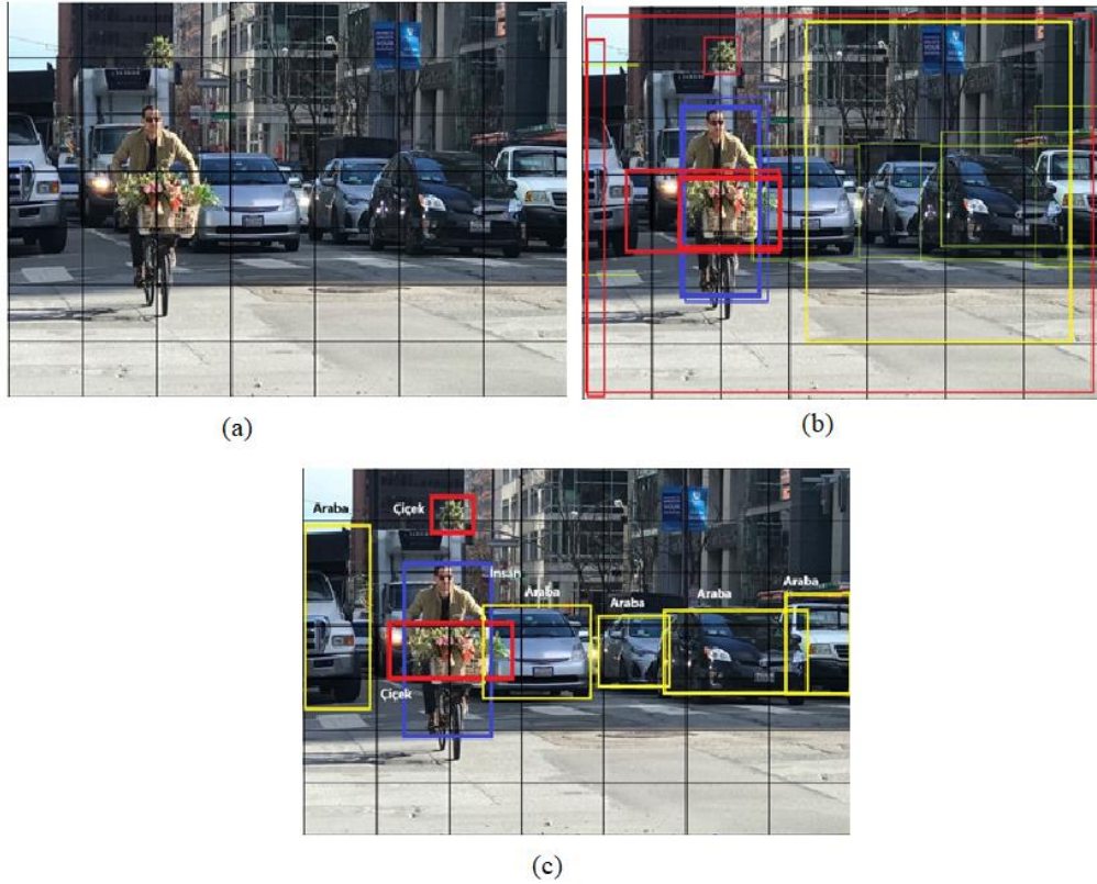
Şekil 3.13. (a) Izgaralı görüntü, (b) Regresyonlu görüntü (c) Sonuçlandırılmış görüntü.
