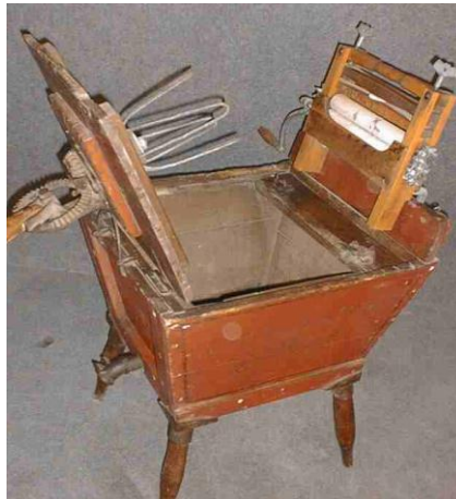
Şekil 2.12. 1890 yılındaki çamaşır makinesi modeli (üreticisi bilinmemektedir) [9]
