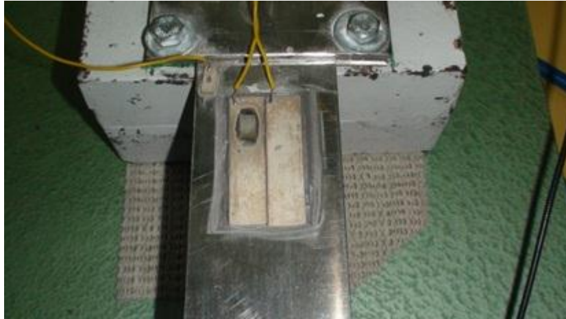
Şekil 4.6. Kiriş üzerine yapıştırılmış piezoelemanlar
