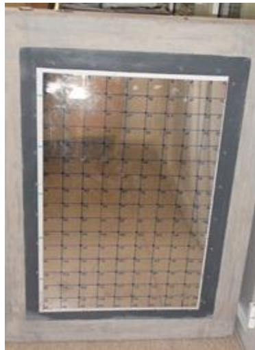
Şekil 4.18. Sac levhanın beton bloğa sabitlenmiş pozisyonu
