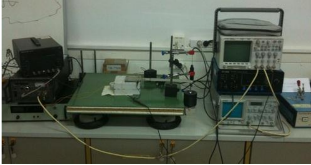
Şekil 4.7. Bir boyutta yapılan titreşim test düzeneği
