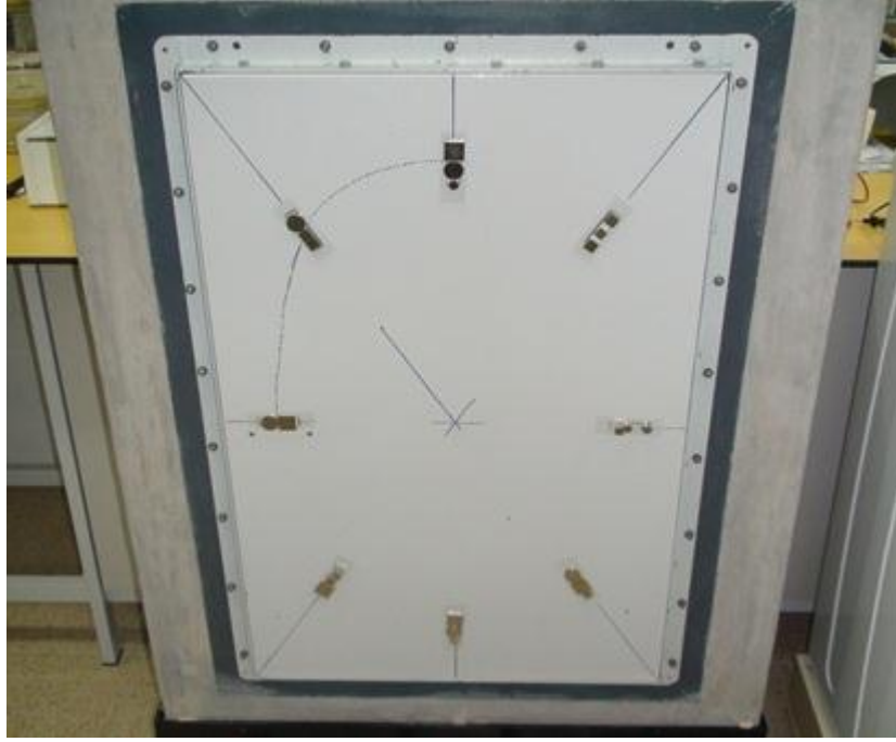
Şekil 4.23. Titreşen levhaya yerleştirilmiş piezoseramik elemanlar
