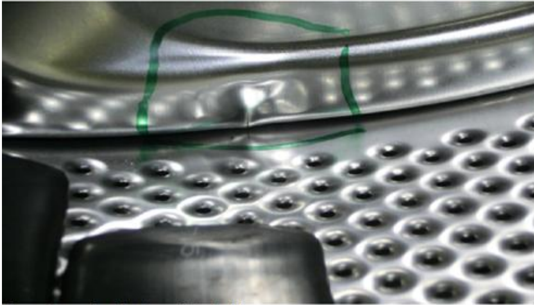
Şekil 5.6: Dengesiz yük testi sonucu oluşan yırtıklar
