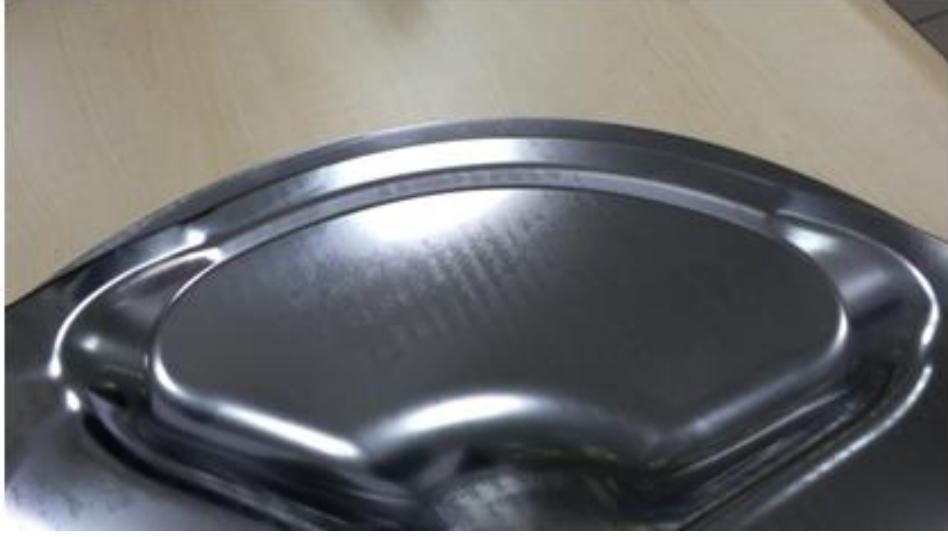
Şekil 5.10: Merkezleme pimlerinin kullanımı ile üretilen arka sac numunesi
