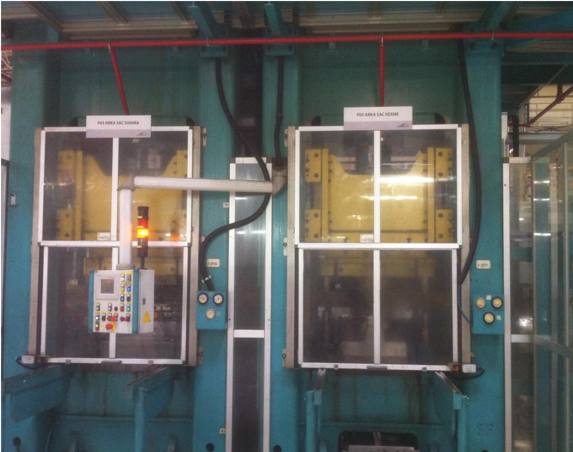
Şekil 5.3 : Derin çekme ve kesme işleminin gerçekleştiği kalıplar
