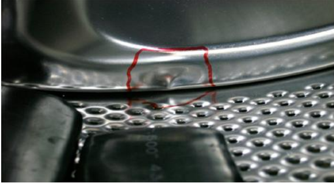
Şekil 5.5: Dengesiz yük testi sonucu görülebilen dalgalanmalar
