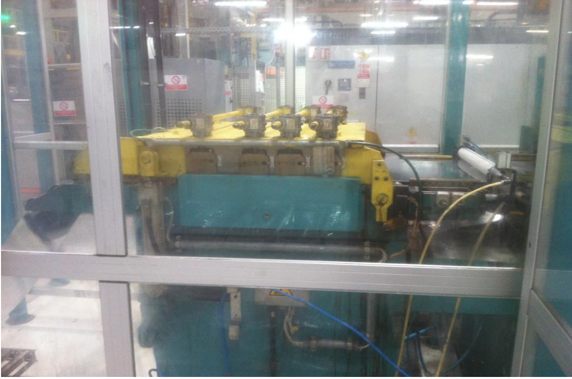
Şekil 5.2 : Doğrultma işleminin gerçekleşmesi
