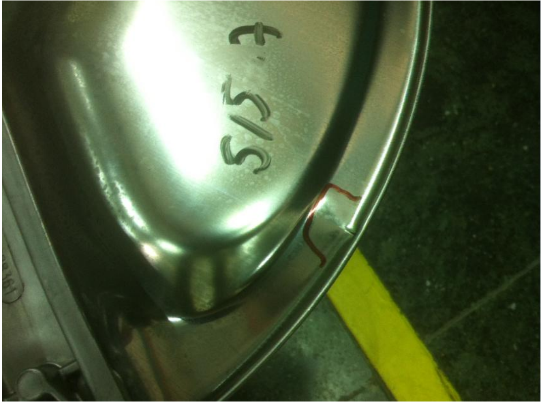
Şekil 5.11: Dengesiz yük testi sonucu % 70.7’de görülen yırtılma
