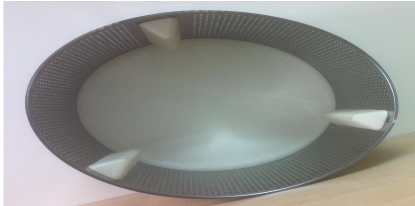
Şekil 2.10 : Tambur çevre sacı üzerinde bulunan plastik perdeler
