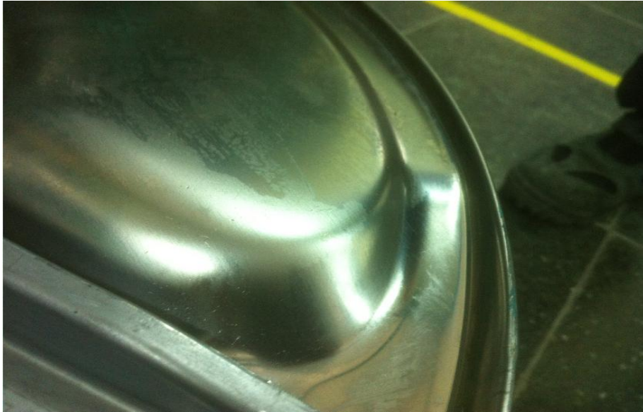
Şekil 5.13: Çalışılan bölgede dengesiz yük testinin ardından oluş an son durum
