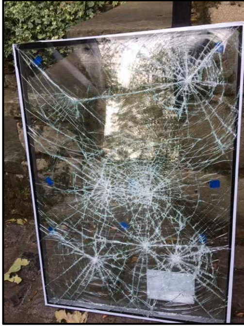
Şekil 2.7. Lamine camın kırılma durumu (Anonymous 6)
