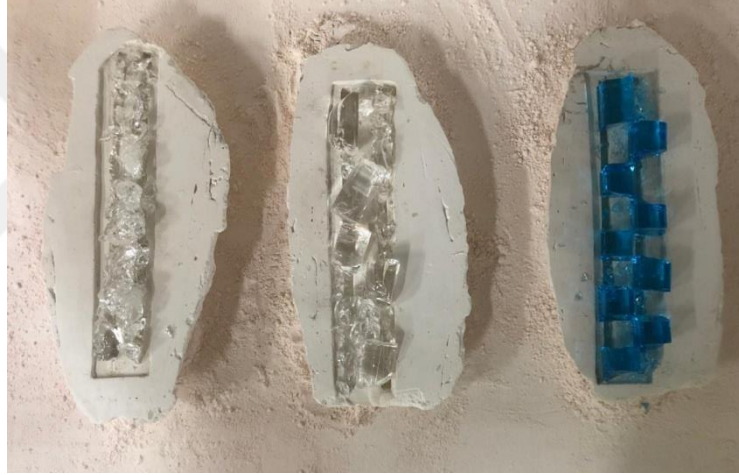
Görsel 4.39. Cam çubuk yönteminde kullanılacak camların fırınlanma öncesi kalıp içerisindeki görüntüleri
