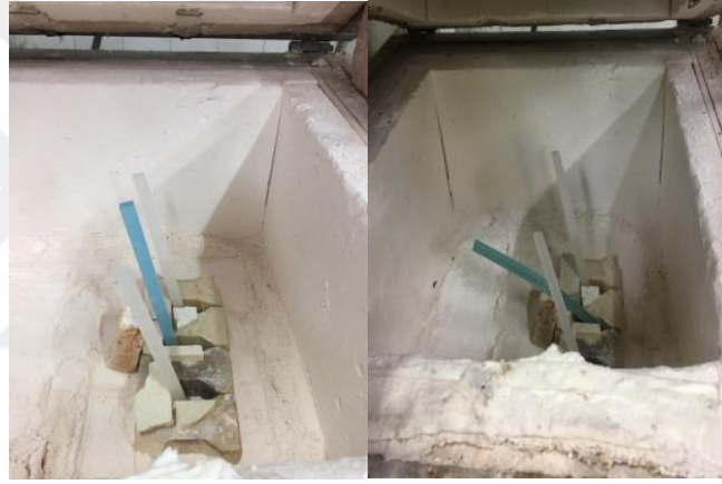
Görsel 4.40. İnce cam çubuklara tavlama sıcaklıkları için ısıtma işlemi uygulanıyor (Ecem Yılmaz fotoğraf arşivi )
