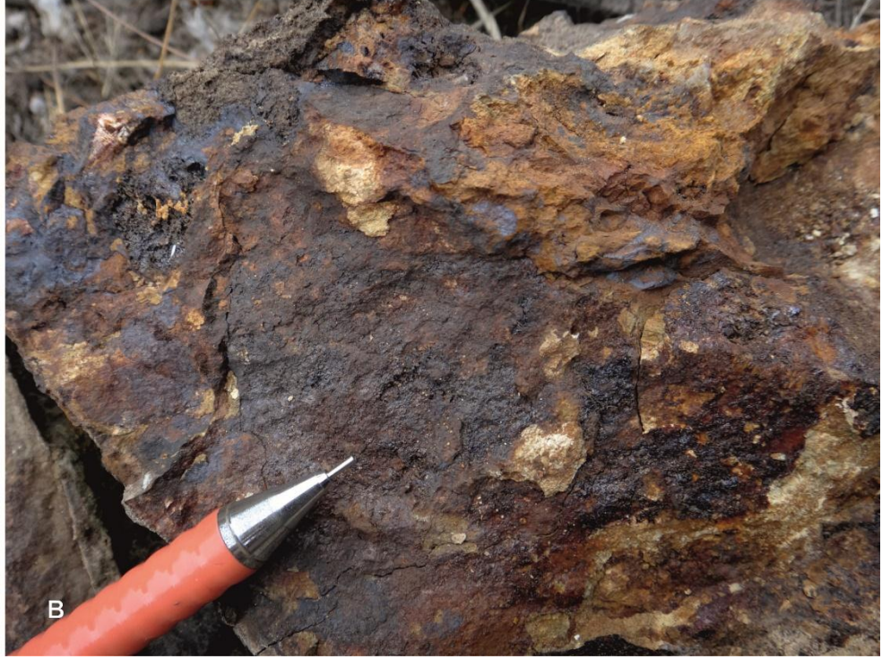
Şekil 3.4 A) Boyalık cevherleşmesi B) Fe-Mn Oksit mineralleri saçınımları
