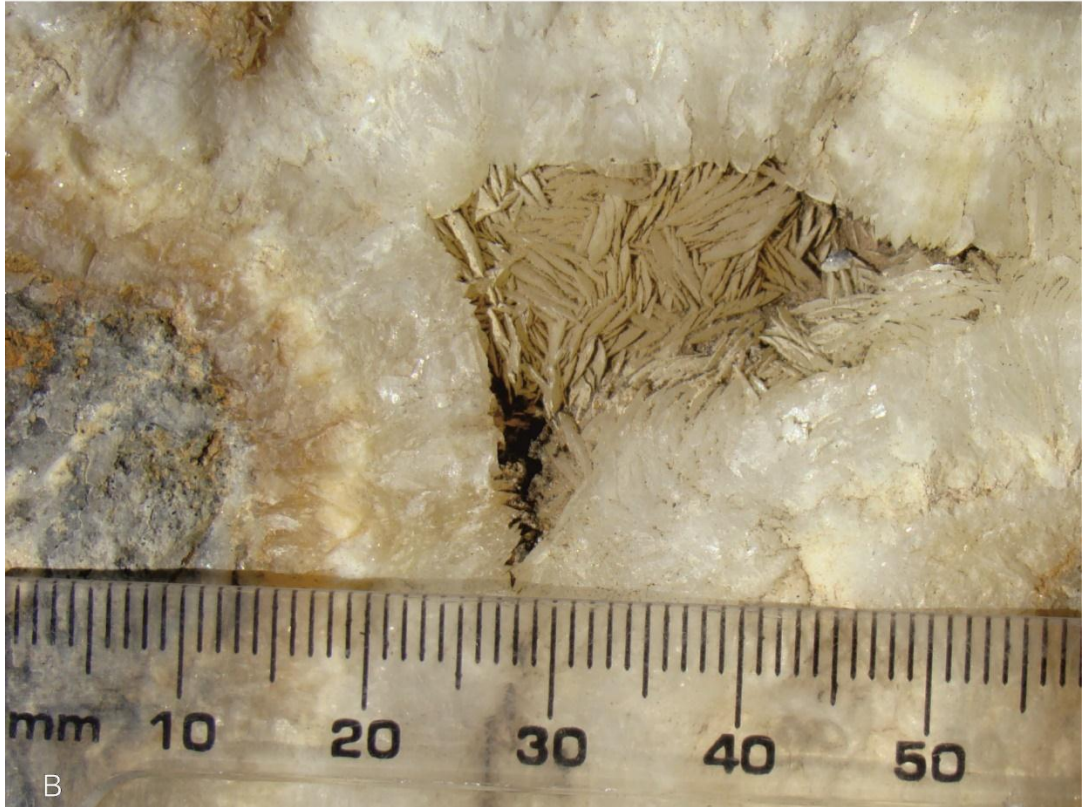
Şekil 3.13A-B) Kolloform dokunun boşluklarında levhamsı kalsit minerali kümesi (494218/ 4236813)
