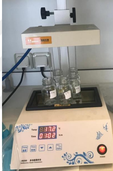
Fotoğraf 3.2. N 2 gazı akışı altında hacim azaltımı.
