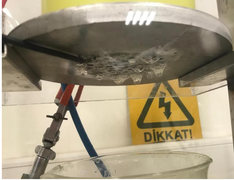
Fotoğraf 2.1. ES prosesi sırasında katot üzerinden meydana gelen H 2 gaz baloncukları.
