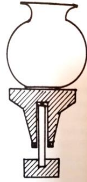
Şekil 8 – Kısa milli yataklı çark üzerinde şekillendirilen el ve ayak tornası (Güner, 1988: 13)
