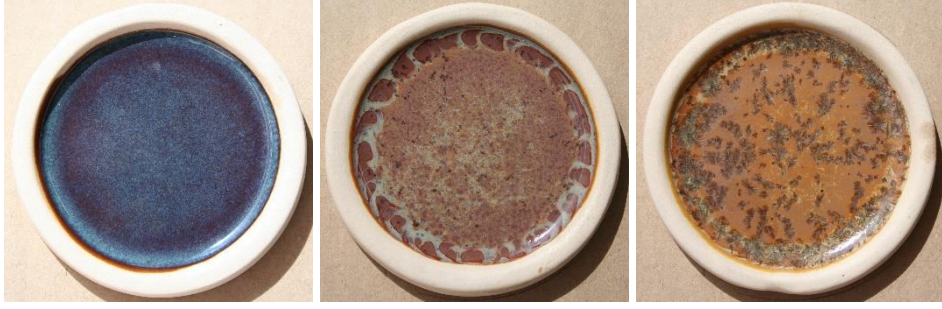
Görsel 1.1. Seydişehir alüminyum tesisleri üretim sonu katı atığı kırmızı çamur ile üretilen pigmentlerin saydam stoneware sıradaki renk ve doku etkileri
