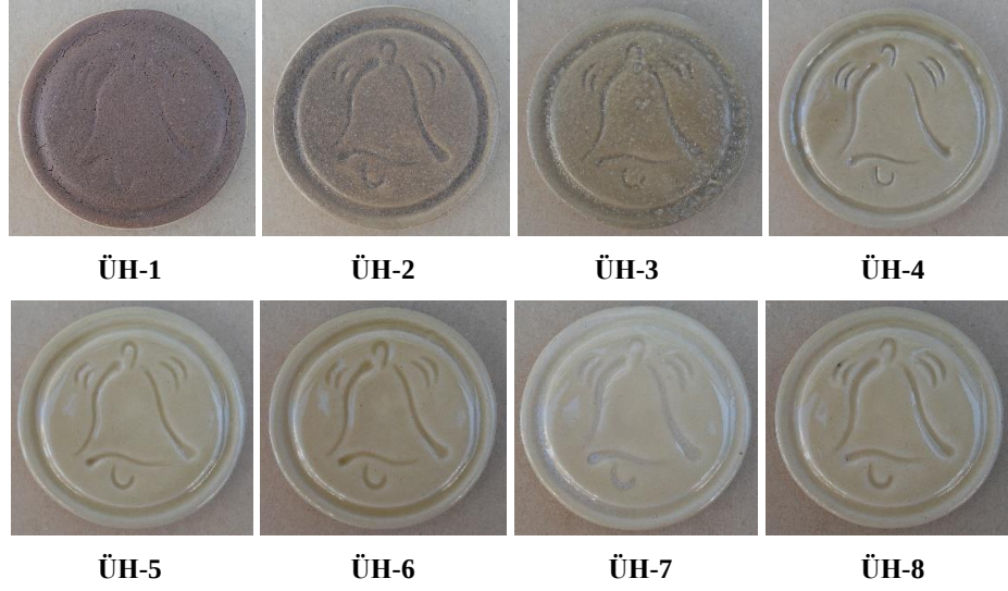
Görsel 3.8. Üleksit ve Çan taşı havuz atığı karışımlarının pişirim sonuçları(1200 °C)
