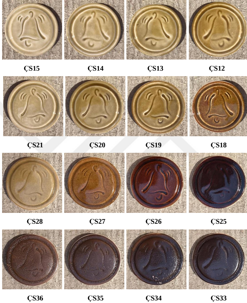
Görsel 3.12. Çan taşı Çakıl atığı-üleksit-kırmızı kil üçlü sistemindeki sırların 1200 °C'deki pişirim sonuçları
