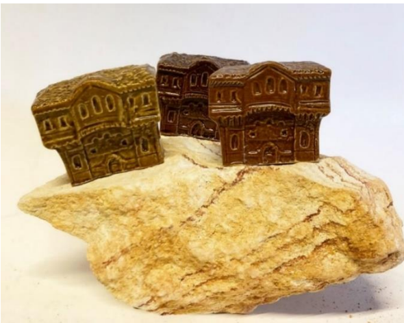
Görsel 3.43. Döküm yöntemi ile şekillendirme ÇS27 (a), ÇS25 (b), ÇS18 (c) kodlu sırlar, daldırma yöntemi, 1200 °C (Özkul, 2023)
