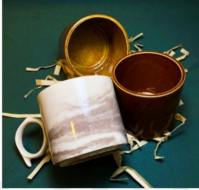
Görsel 3.33. Döküm yöntemi ile şekillendirme ,ÇS18, ÇS25 kodlu sırlar, Çakıl atık katkılı mermer desen, karışık sırlama yöntemi, 1200 °C (Özkul, 2023)
