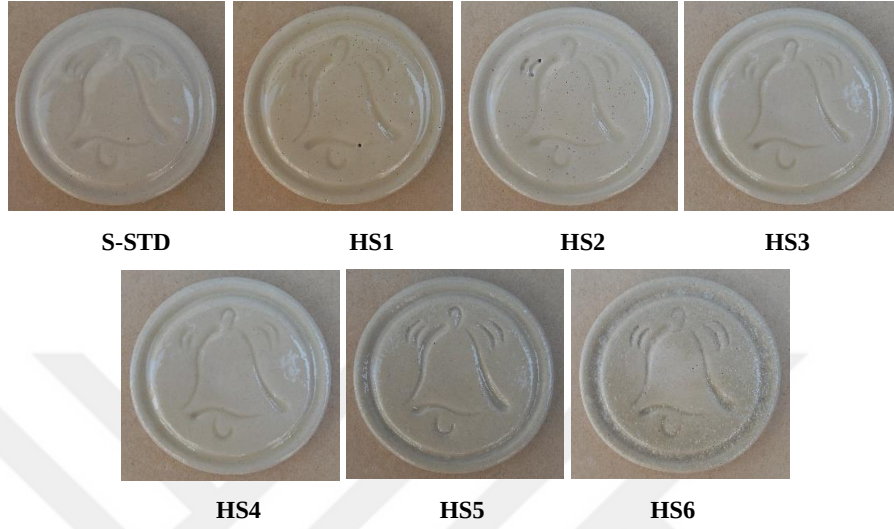
Görsel 3.20. Çan taşı havuz atığı ilaveli saydam sırların 1200 °C sıcaklıktaki pişirim sonuçları
