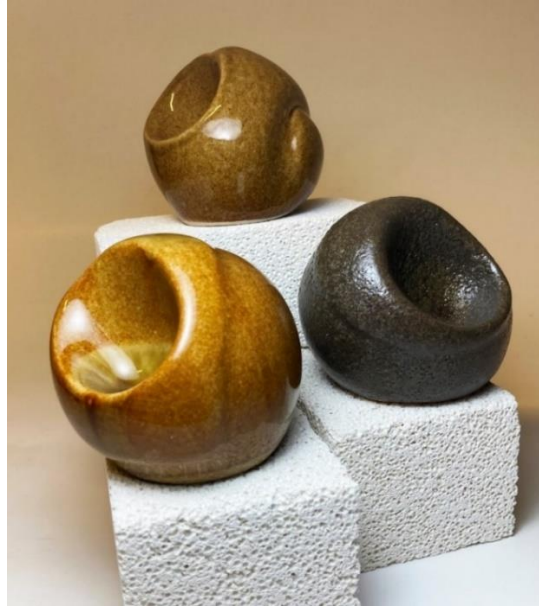
Görsel 3.42. Döküm yöntemi ile şekillendirme ÇS18 (sol), ÇS27 (üst), ÇS26, HS6-%3 Fe 2 O 3 (sağ) kodlu sır, püskürtme yöntemi, 1200 °C (Özkul, 2023)
