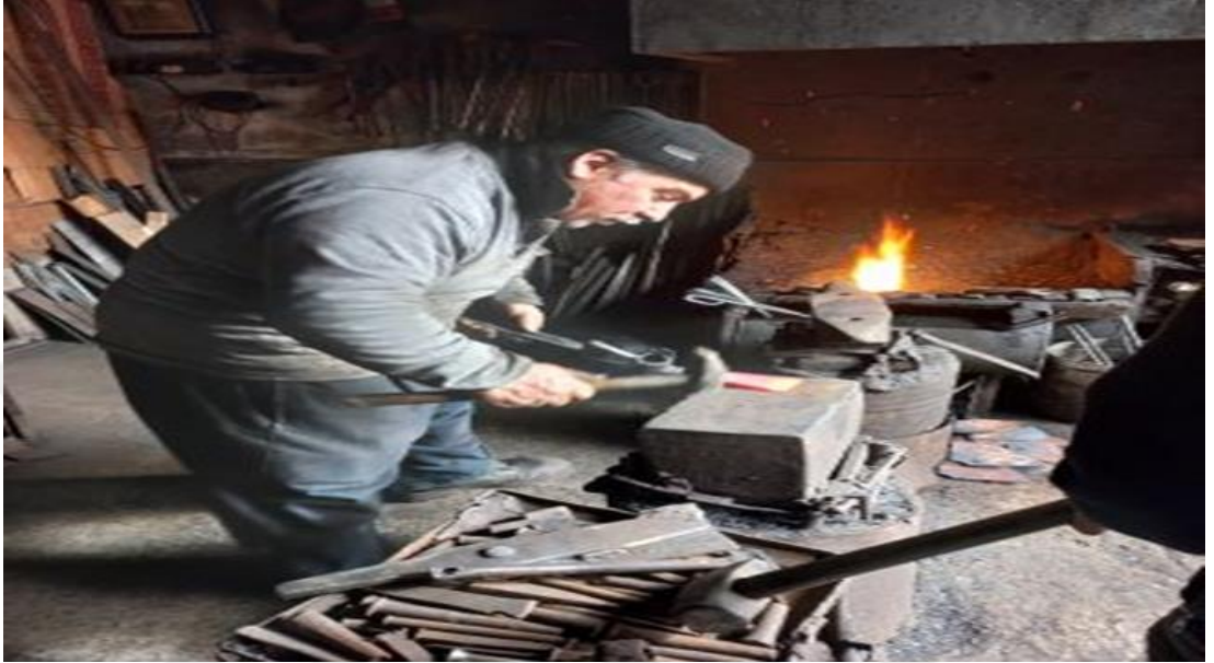
Fotoğraf 4.7: Demirin dövülerek şekillendirilme aşaması
