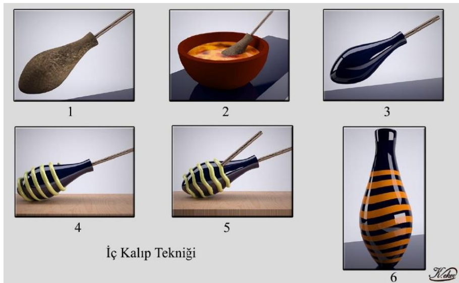
Resim 7: İç kalıp tekniği
