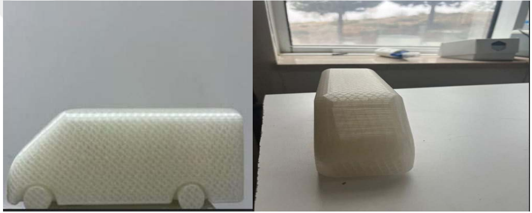
Şekil 4.3. T2 modelinin 1:28 ölçekli modelinin üretimi
