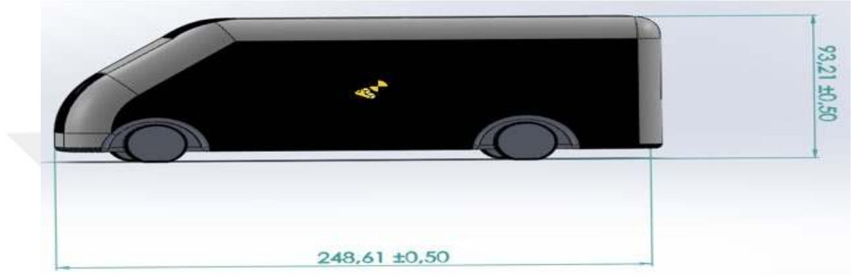
Şekil 4.1 T2 modelinin 1:28 ölçekli modeli
