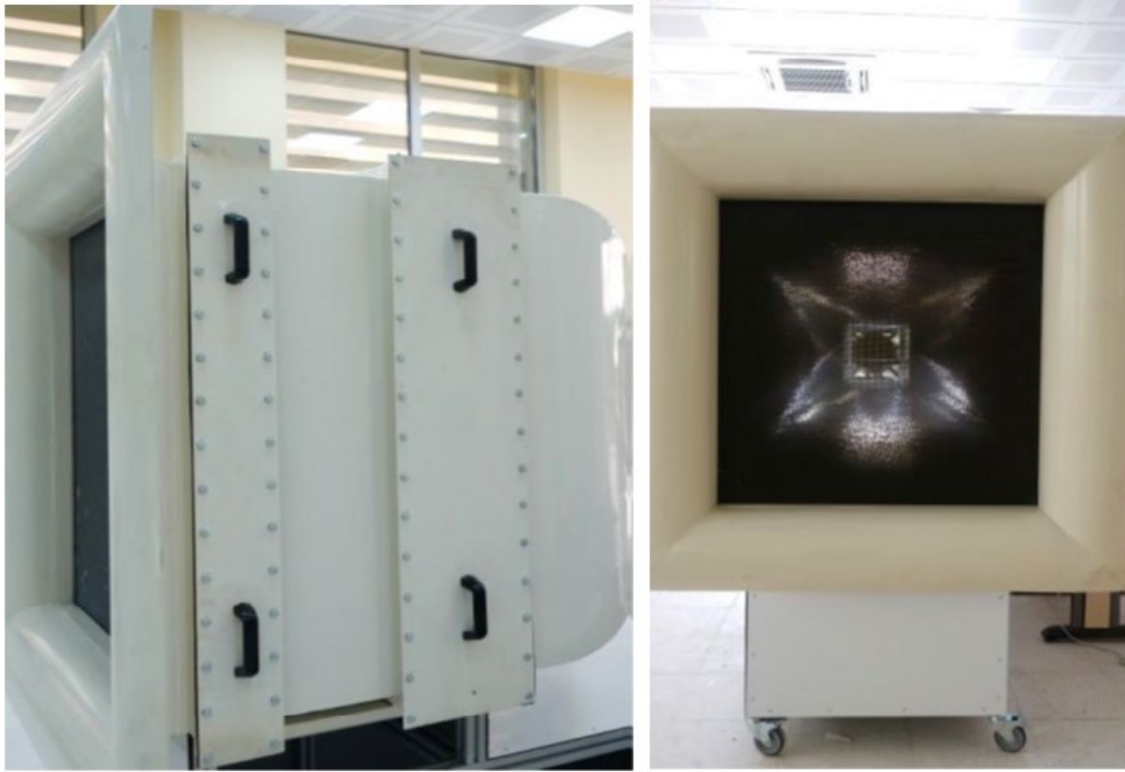
Şekil 2.17. Rüzgar tünelinin inlet kesiti [47].
