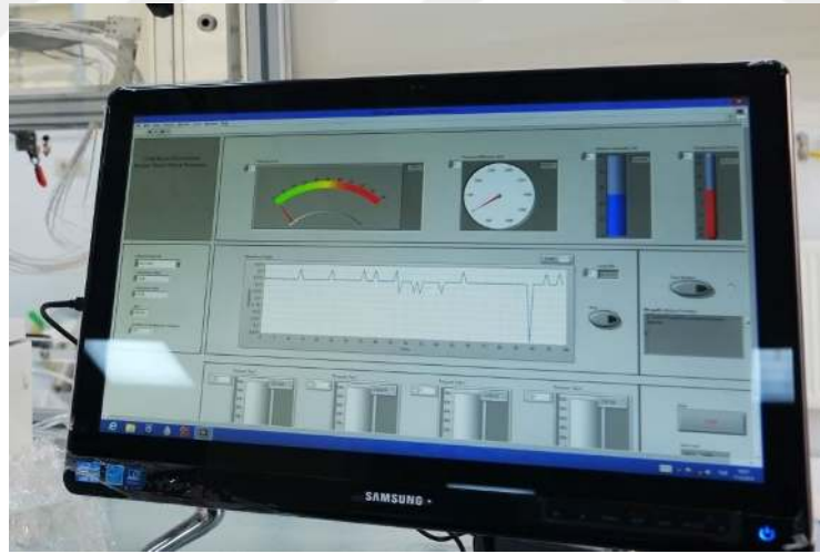
Şekil 2.20. Rüzgar tüneli veri akışı için kullanılan LABVIEW programı[47].
