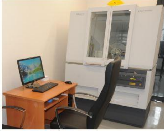
Şekil 2.2. Deneysel çalışmalarda kullanılan x-ışını difraktometresi
