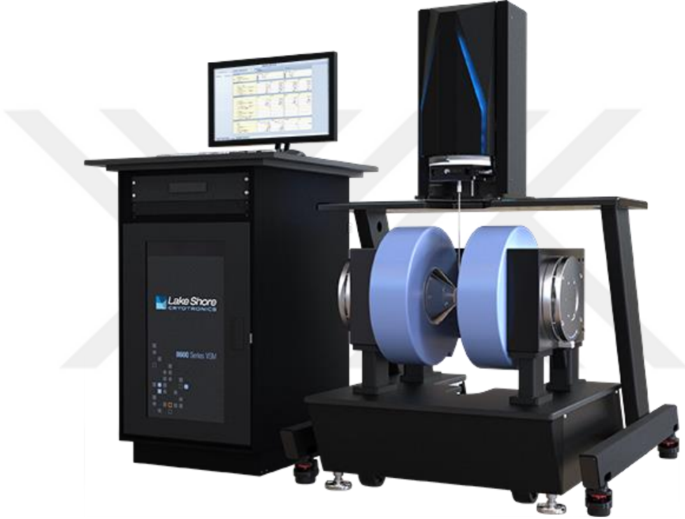
řekil 2.4. Deneysel alıřmalarda manyetik zellikleri karakterize etmek iin kullanılan titreřimli rnek manyetometresi
