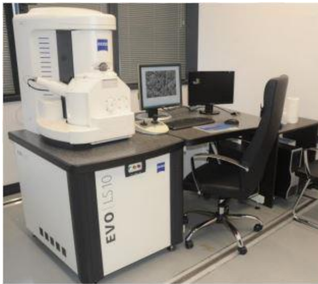
Şekil 2.3. Deneysel çalışmamalarda mikro yapı analizlerinde kullanılan taramalı elektron mikroskobu
