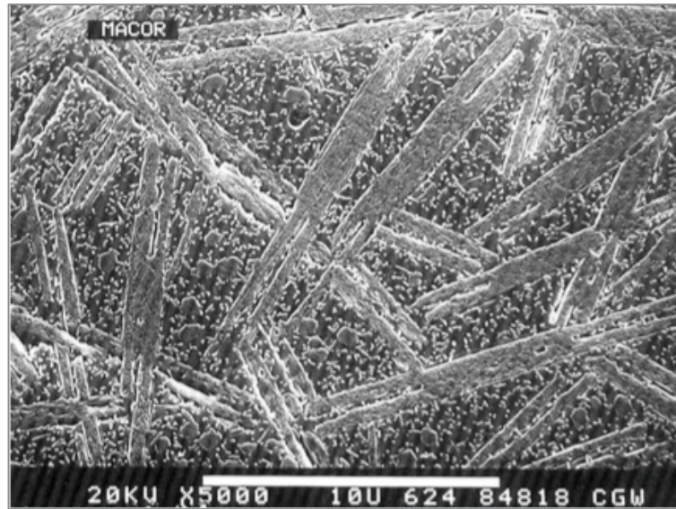
Şekil 2.21. MACOR® MGC işlenebilir cam-seramiğinin 5000X büyütmedeki mikroyapısı [63].
