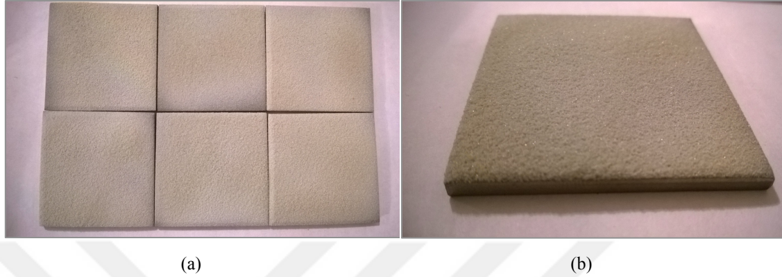
Şekil 5.11. AISI 304 paslanmaz çelik üzerine uygulanan CAS kaplamaların makro görüntüleri
