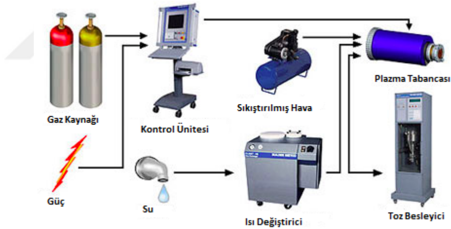
Şekil 4.7. Plazma sprey sisteminin bileşenleri [85].
