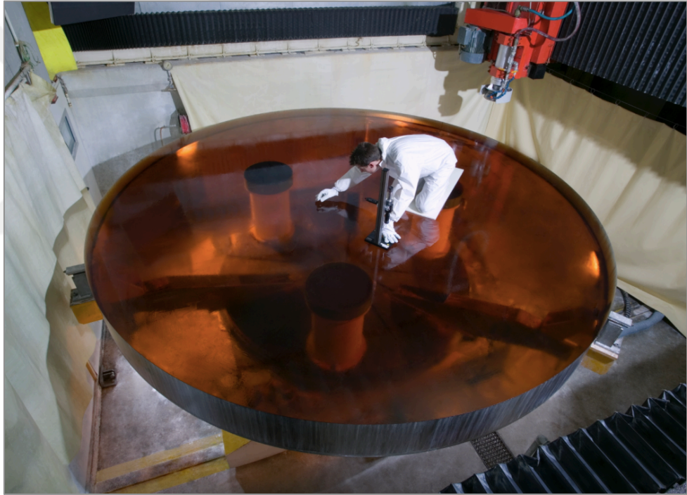
Şekil 2.20. Zerodur® cam-seramik teleskop aynası [61].
