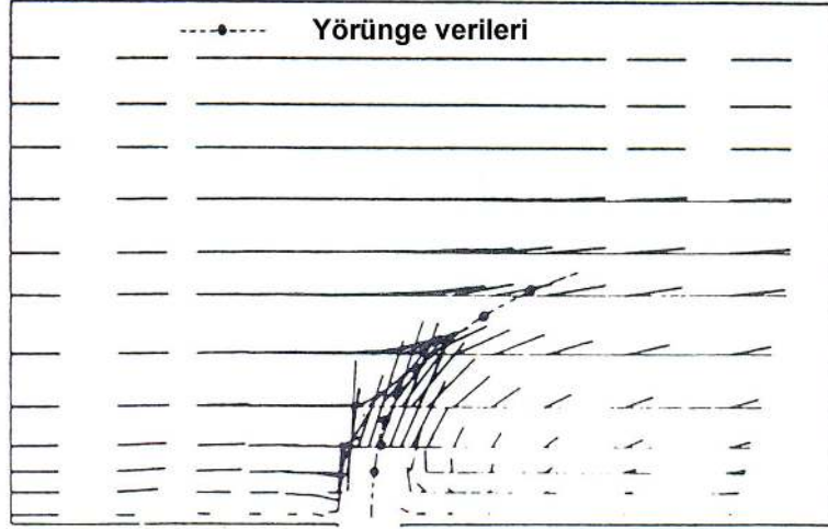
Şekil 2.14 V_e=0,25 hız oranı için çapraz akıştaki jetin hesaplanmış hız vektörü çizimi[79]
