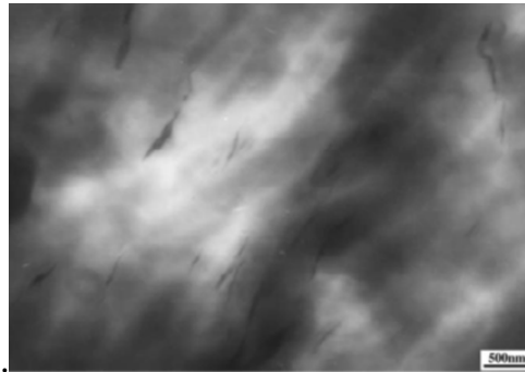
Şekil 2.4. VTMS-g-PE/OMT nanokompozitlerinin TEM görüntüsü (Lu et al. 2006)
