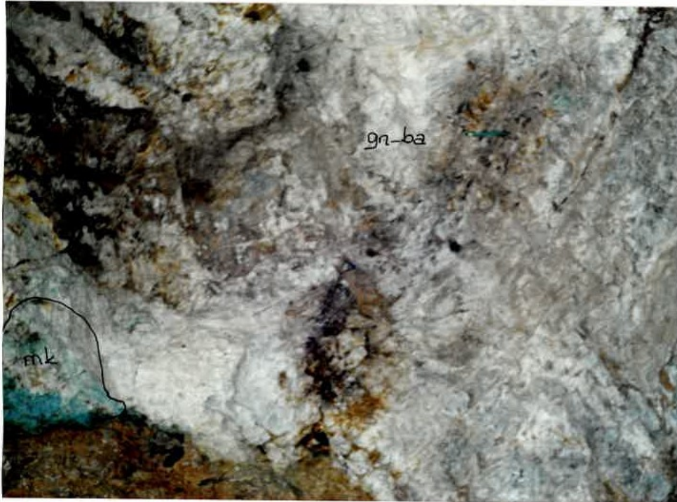
Foto 14: Subaşı Ocağındaki galenli-barit (gn-ba) cevherleşmesi ve malakit (mk) gelişimi.
