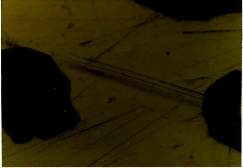
Foto 40: Galen (gn) içerisindeki sfalerit (sf.) kapalımları. (II.Nikol, 150 büyütme).
