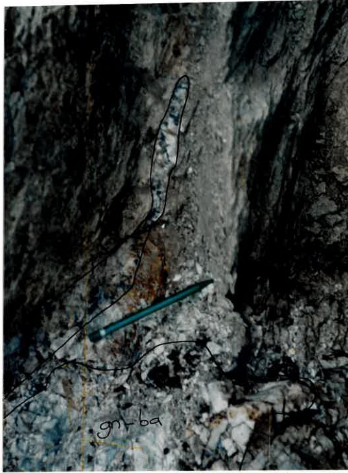
Foto 24: Dikmen Tepe Ocağında kireçtaşları (kçt) içerisinde yataklanan galenli-barit (gn-ba) cevheri.
