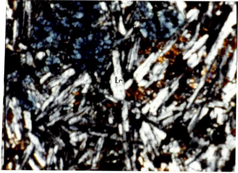
Foto 11: Ofitik doku gösteren dolerit (II.Nikol, 40 büyütme) lr : labrador cl : Klorit op : Opak mineraller
