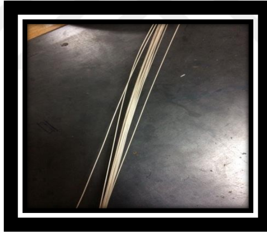
Resim 52. Gümüş tellerin eşit boylarda kesilmesi (Fotoğraf: C.Y. Göker Arşivi)
