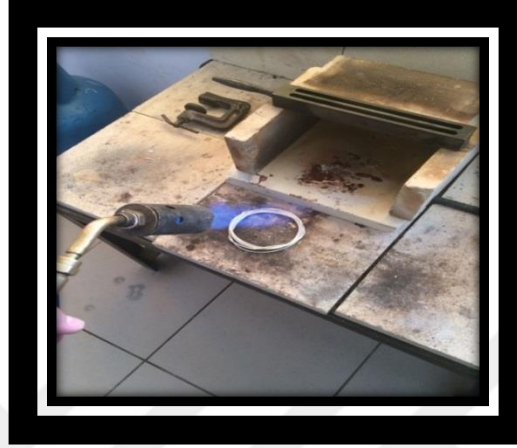
Resim 50. Gümüşün tavlama işlemi (Fotoğraf: C.Y. Göker Arşivi)
