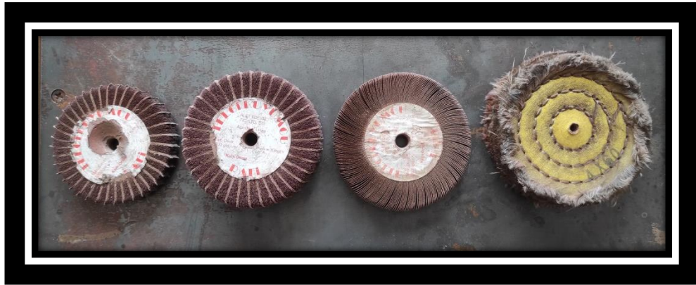
Resim 35. Cila Motoruna Takılan Keçe ve Zımparalar (Fotoğraf: C.Y. Göker Arşivi)
