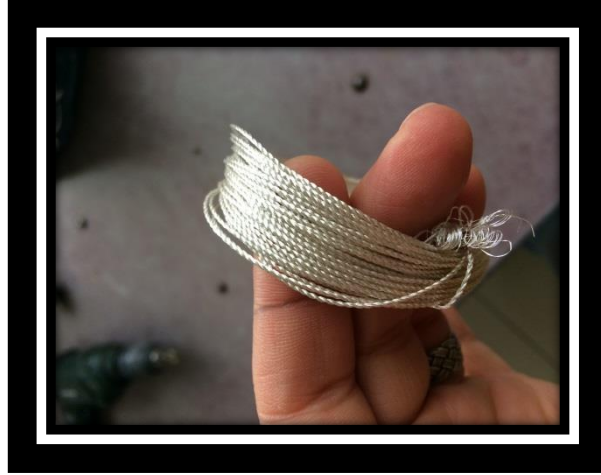
Resim 71. Burguları yapılmış ve sarılmış iplik halinde tel (Fotoğraf: C.Y. Göker Arşivi)
