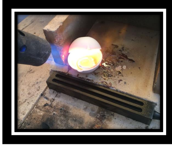
Resim 47. Has gümüşün eritilmesi (Fotoğraf: C.Y. Göker Arşivi)
