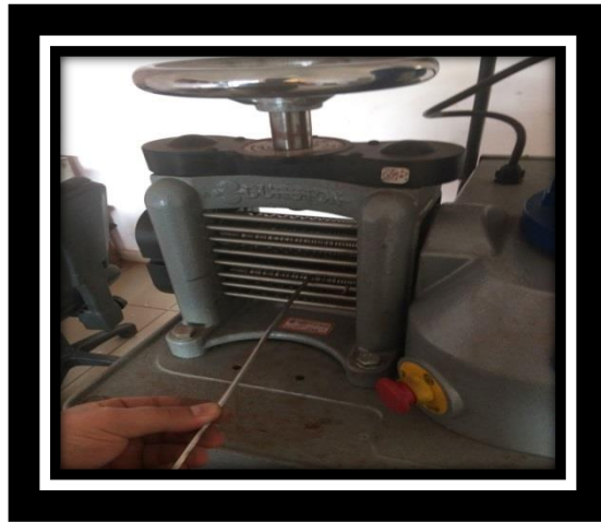
Resim 49. Gümüşün silindirde çekilmesi (Fotoğraf: C.Y. Göker Arşivi)
