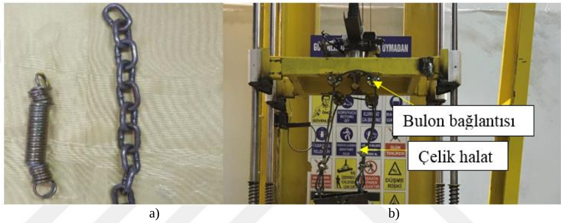
Şekil 5.20. a) Kullanılan ilk bağlantı detayları b) Tercih edilen bağlantı detayı
