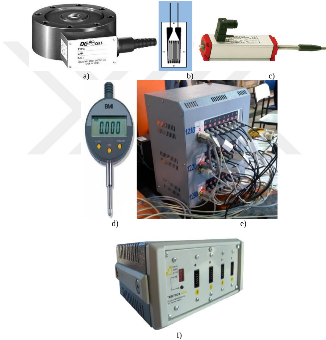
Şekil 5.13. a) Yük hücresi b) Gerinim pulu c) Potansiyometre d) Mititoyo (yerdeğiştirme ölçer) e) 32 kanallı veri toplama sistemi f) 4 kanallı veri toplama sistemi
