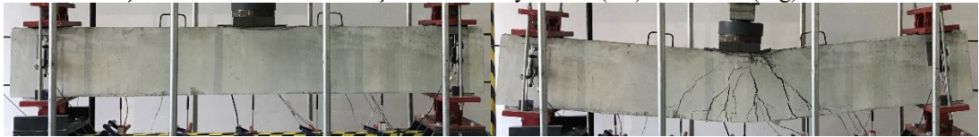
c) H-FS-R numunesi için statik deney öncesi (sol) ve sonrası (sağ) durum
