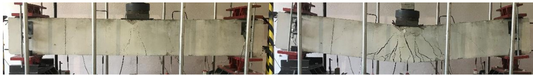
a) H-FC-E2 numunesi için statik deney öncesi (sol) ve sonrası (sağ) durum
