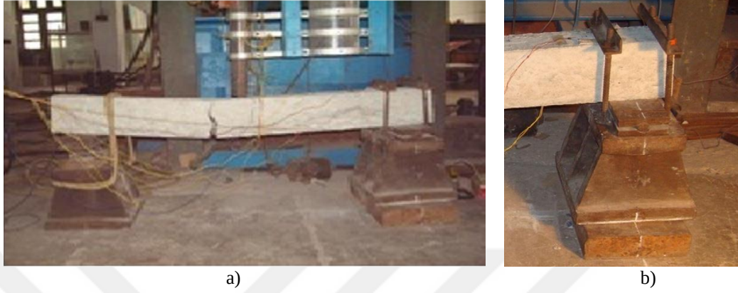
Şekil 3.10. a) Çarpma deneylerinde kullanılan deney düzeneği b) Mesnet detayı
