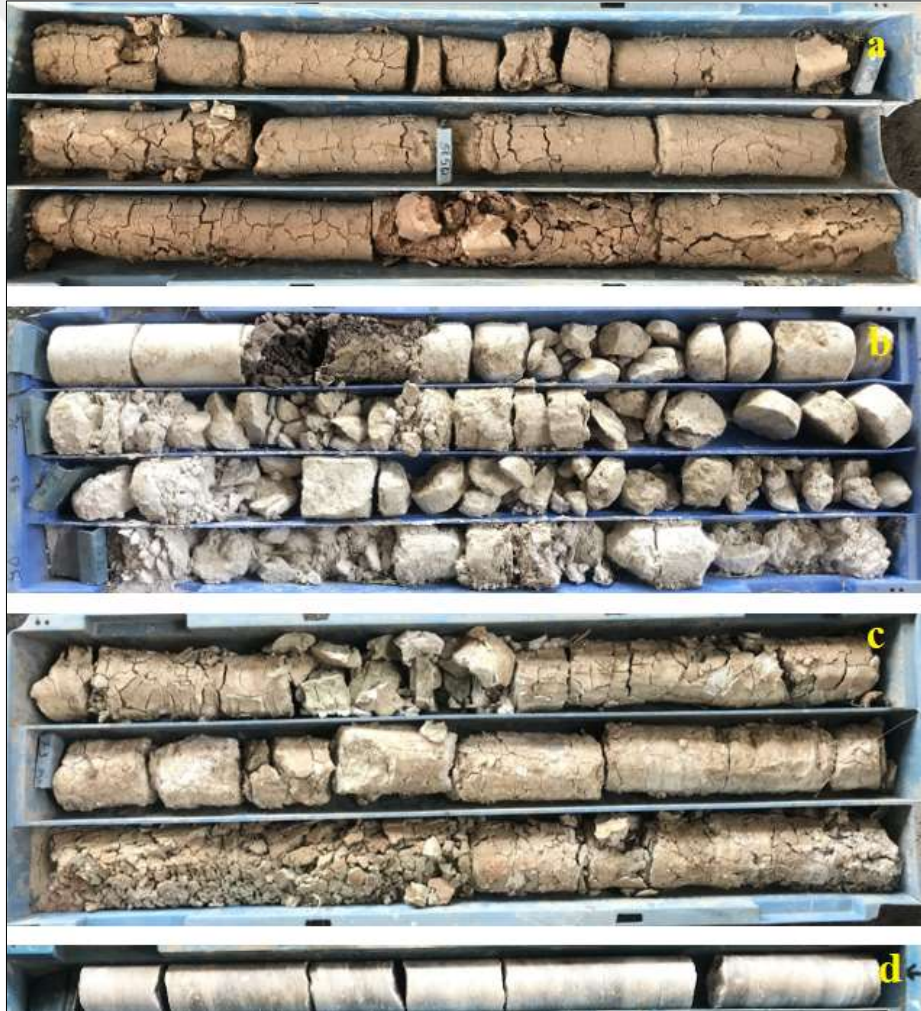
Şekil 4.18 Ç-2 nolu sondaj kuyusuna ait karot fotoğrafları (TKİ Kömür Arama Projeleri Raporu, 2018). a) Sondajın üst seviyelerindeki kahve renkli, kuruma çatlaklı çamurtaşı seviyeleri, b) kireçtaşı ve organik maddece zengin kiltası seviyeleri, c) bej, yeşil renkli kiltası seviyeleri d) Temele ait kristalize kireçtaşı.
