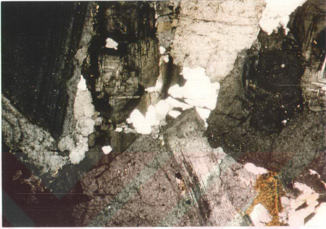
Fotoğraf 3.8: Taze granodiyoritteki ayrılmamış mineraller (kuvars, plajiolklas ve biotit) ile az miktardaki mikroçatlaklar (Büyütme: X25)
