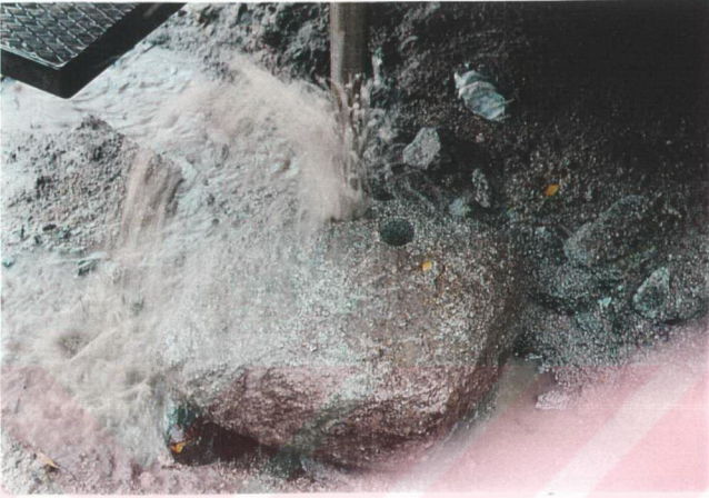
Fotoğraf 3.5: Orta derecede ayrılmış örneklerin bloklardan sondaj makinesiyle alınması
