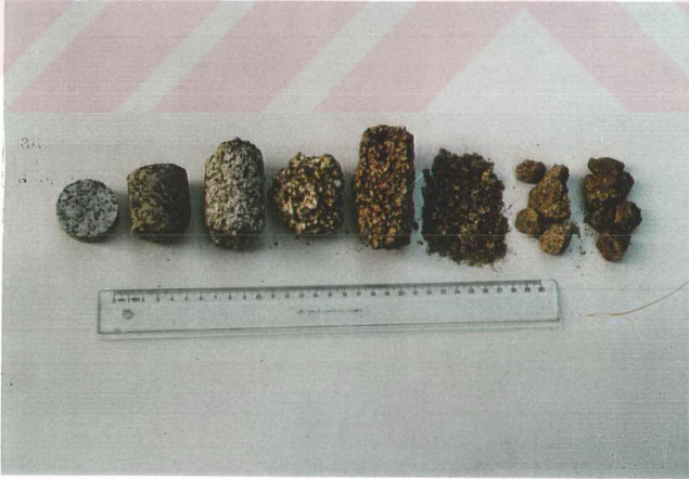
Fotoğraf 4.1: Granodiyorit farklı ayrışma derecelerindeki örnekleri
