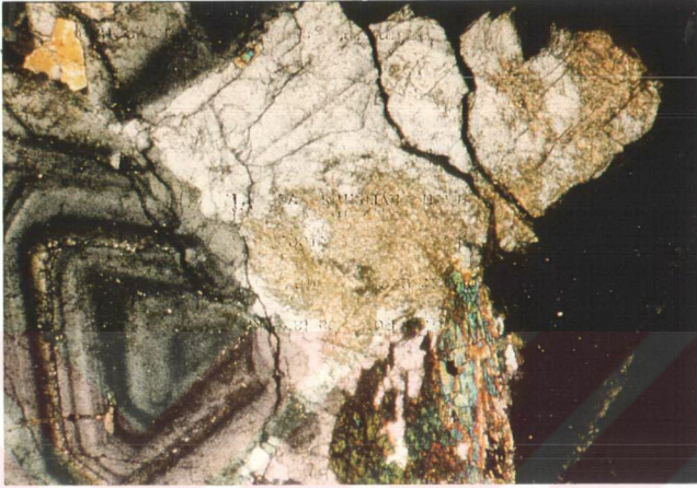
Fotoğraf 3.10: Yüksek derecede ayrılmış granodiyoritteki zonal ayrılmaya uğramış plajyoklaslar ve transgranüler (taneleri kateden) mikroçatlaklar (Büyütme: X25)
