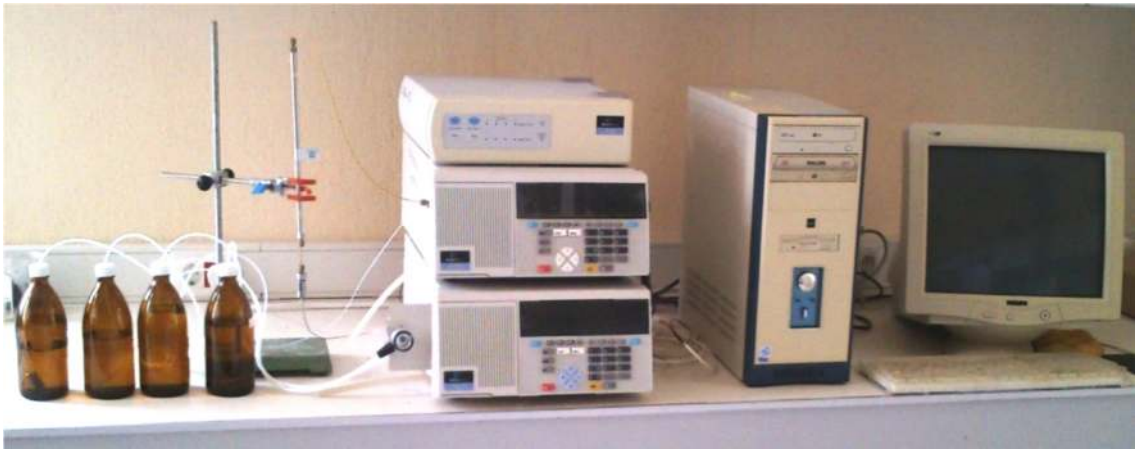
Şekil 5.2. Perkin Elmer Series 200 Marka HPLC cihazı.
