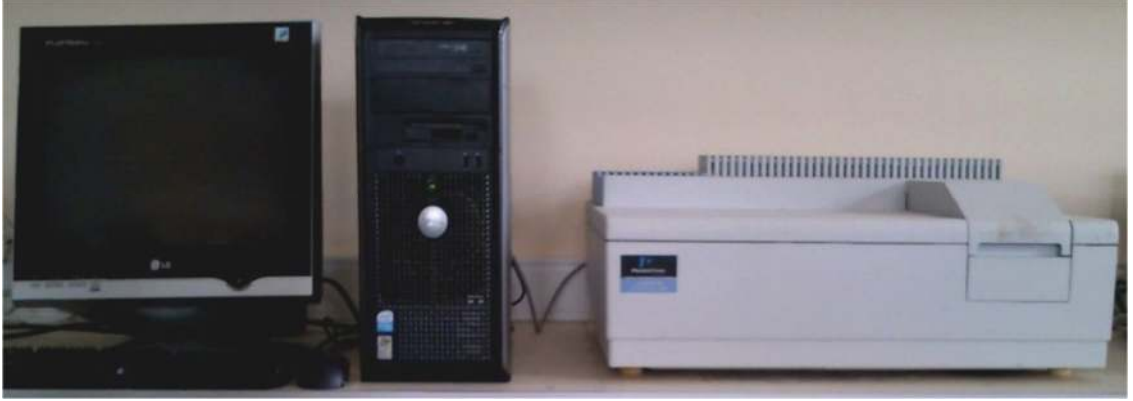
Şekil 5.1. Perkin Elmer Lambda 35 UV-Vis Spektrofotometre.
