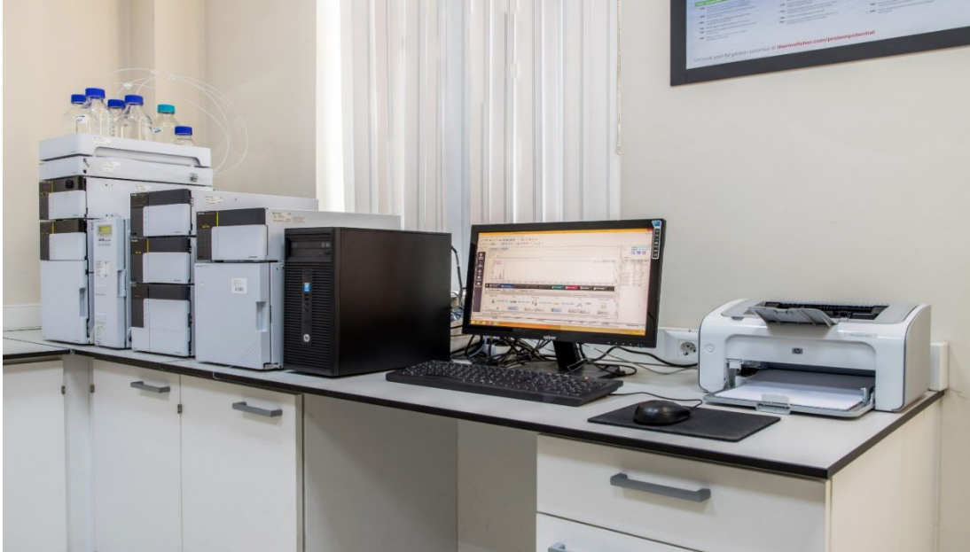
Şekil 9. Çay örneklerinin HPLC okuma işlemine ilişkin görünüm
