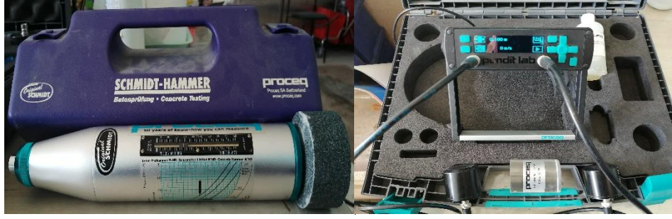
Şekil 15. Tahribatsız deney cihazları (Schmidt çekici ve ultrases geçiş hızı cihazı)
