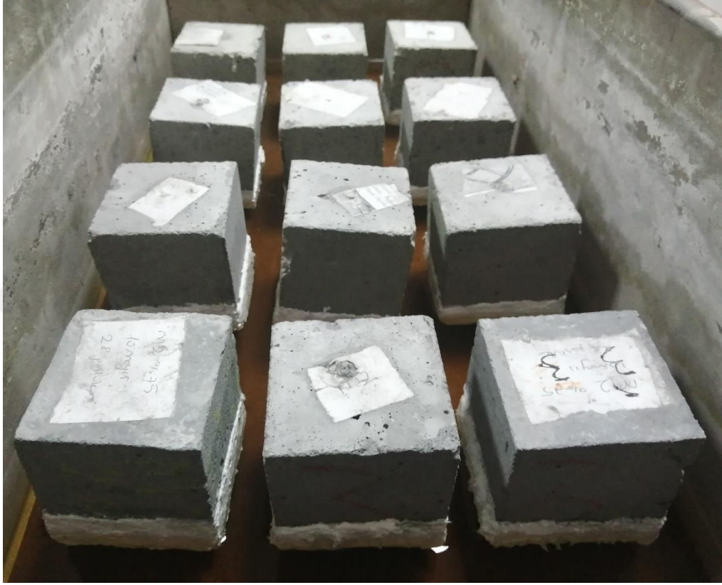
Şekil 18. Kapiler su emme deney düzeneği
