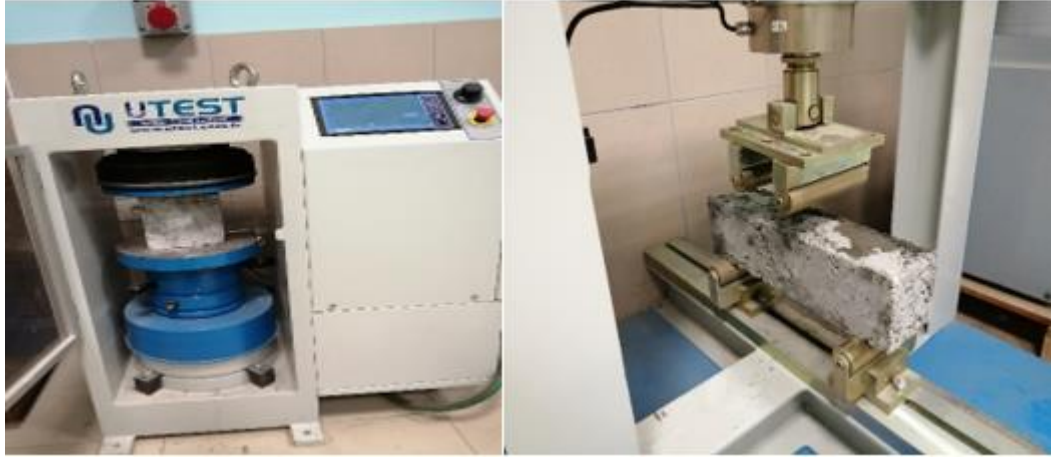
Şekil 16. Basınç ve eğilme dayanımı test cihazı
