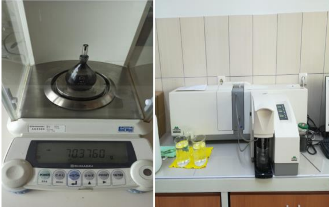
Şekil 10. Piknometre ve lazer parçacık boyutu analizörü
