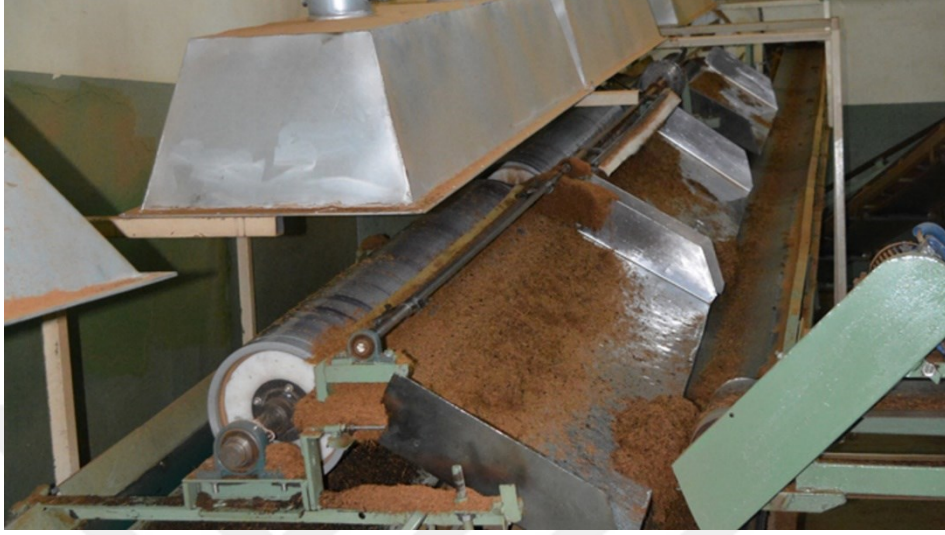
Şekil 2.8. Elektrostatik alan oluşturarak çaydan lif ve toz alma
