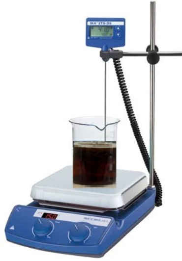
Şekil 3.3. Çay lifinin ısıtıcılı manyetik karıştırıcılı ile demlenmesi
