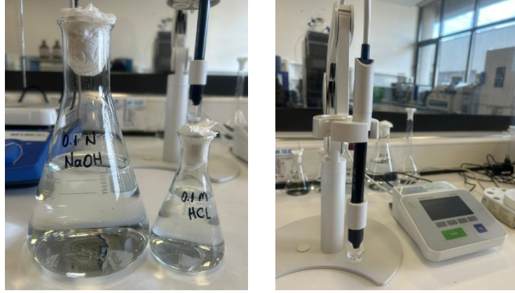
Şekil 3.5. Çay lifi ekstraktlarının pH'larının ayarlaması
