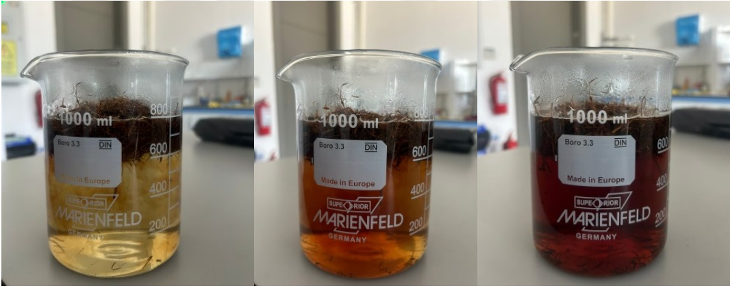
Şekil 3.4. Çay lifinin ekstraktraksiyonu ( 95°C, 15 dakika)
