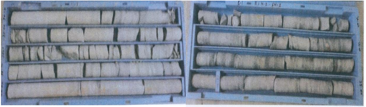
Şekil 3.7 Çaycuma Formasyonu'na ait killi seviyeden alınan karot örneklerinden görünüm.
