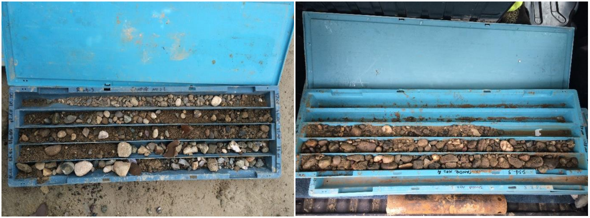
Şekil 3.6 Alüvyonda yapılan sondajlara ait karot örnekleri
