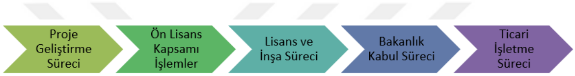
Şekil 26. Rüzgar enerji santrali kurulumunda izlenilecek işlem adımları (TÜREB, 2024)
