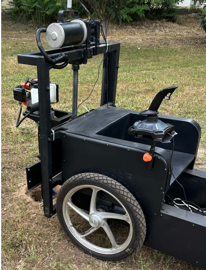
Şekil 3.16. Manuel kontrol için kullanılan el kumandasının robot üzerindeki konumu
