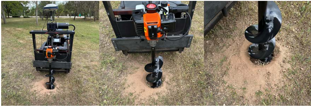
Şekil 4.3. Çukur açma işlemi için çalışma alanındaki mobil robotun görüntüleri
