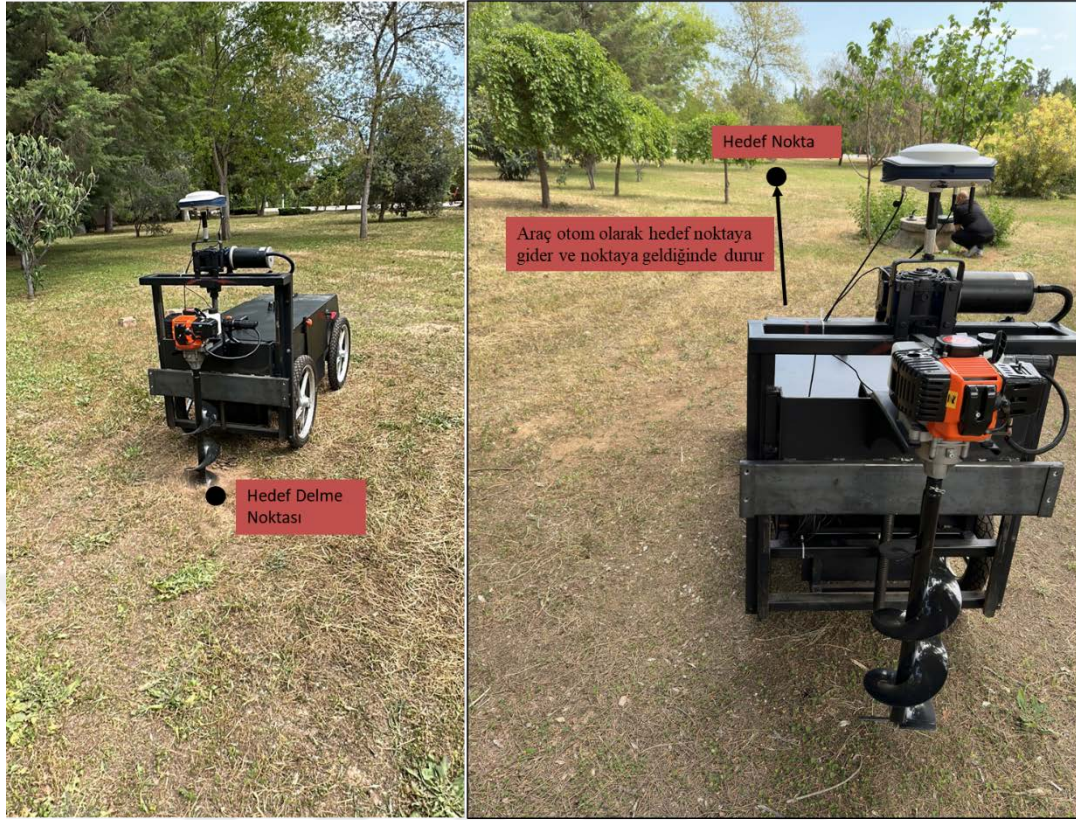
Şekil 3.27. Otonom burgu robotu ile çukur açma noktalarının doğrulunun belirlenmesi
