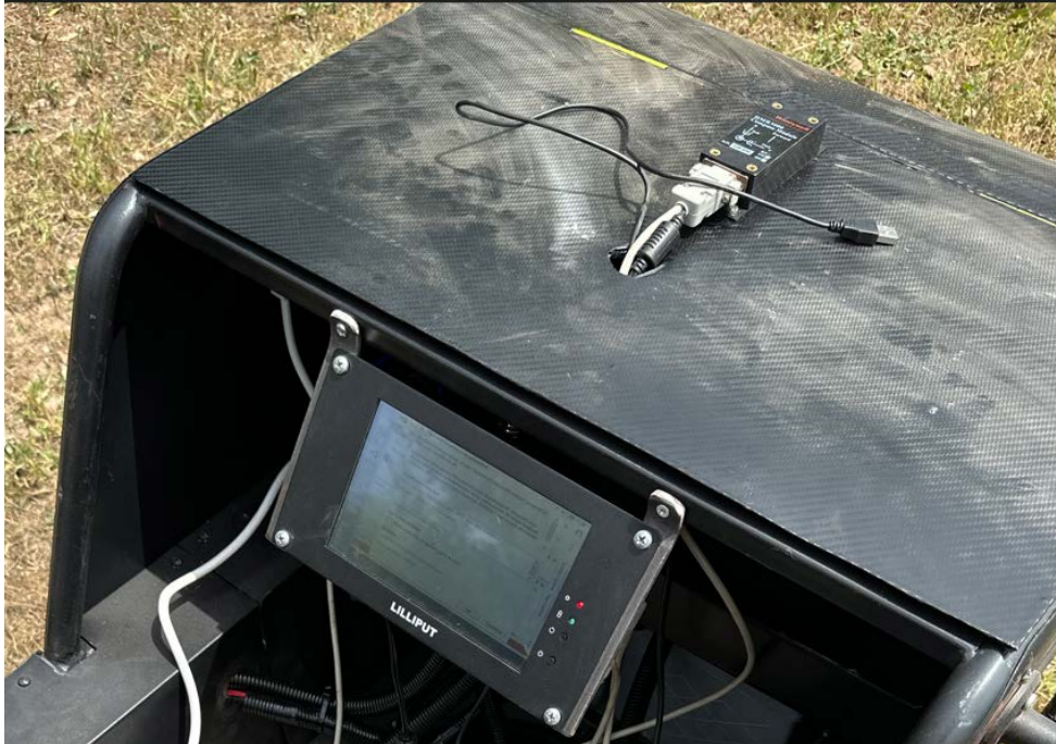
Şekil 3.18. Pusulanın robot üzerindeki konumu
