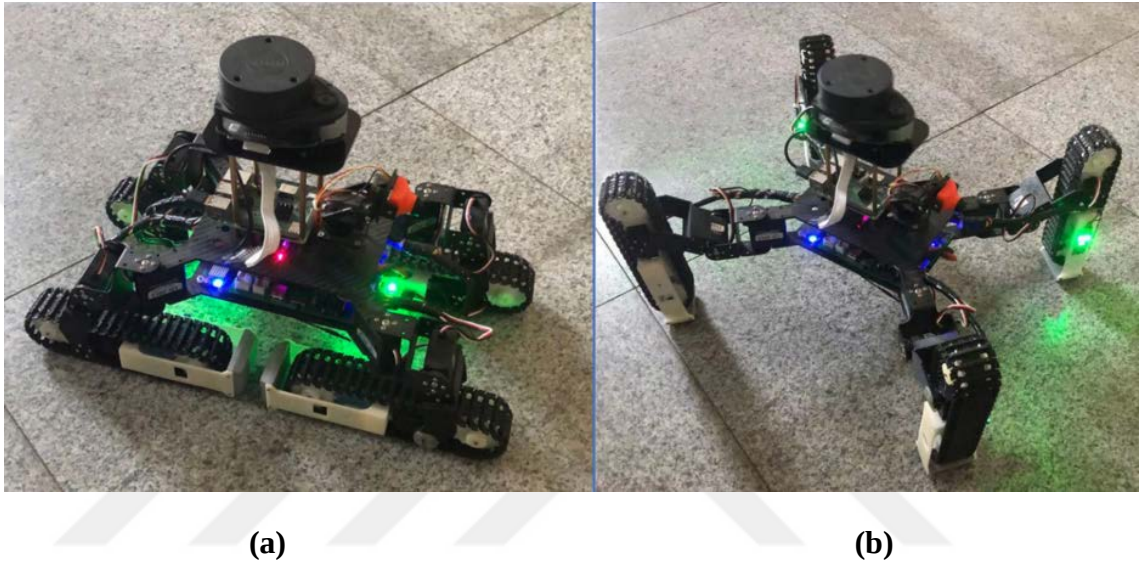
Şekil 2.3. Dört ayaklı robot; a) paletli modda; b) bacaklı modda
