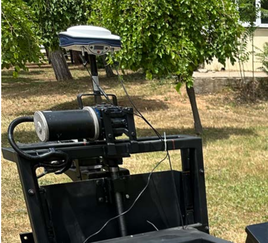
Şekil 3.15. Promark 500 GPS alıcısının mobil robot üzerindeki yerleşimi
