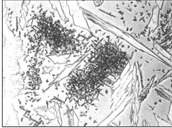
Görsel 2.11. Yapıda oluşan ikincil östenit fazı görseli [5].
