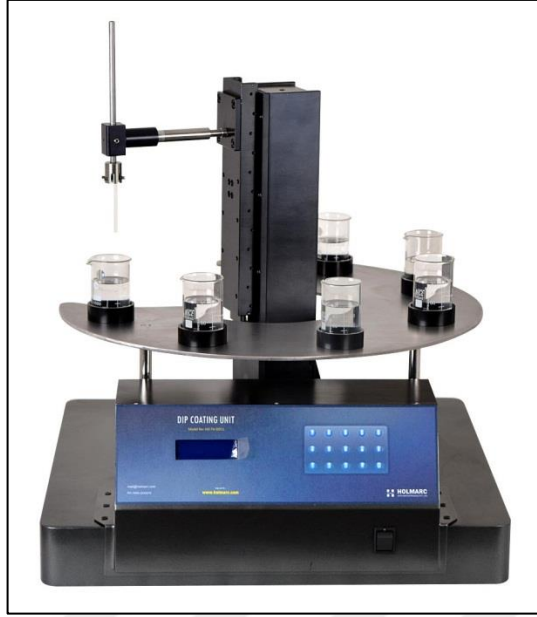
Şekil 2.5 Tek altlıklı SILAR sistemi (Holmarc Optomechatronics)
