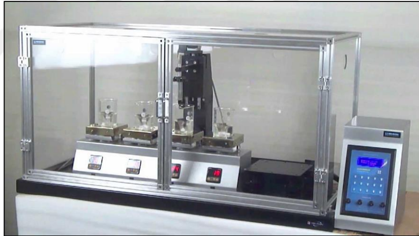
Şekil 2.6 İzoleli ve manyetik karıştırıcılı SILAR makinası (Holmarc Optomechatronics)
