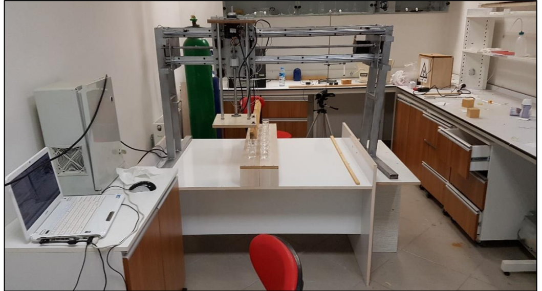
Şekil 4.6 CdO ince film deney düzeneği
