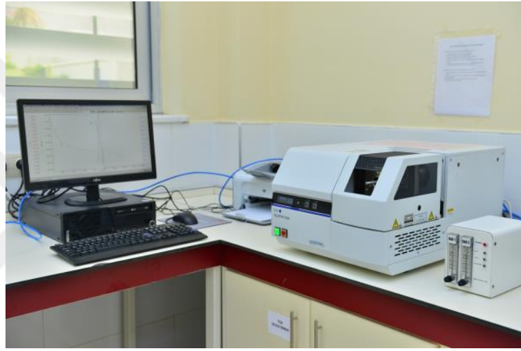
Şekil 3.9. TG-DTA Ölçüm cihazı- Hitachi SII Exstar 7300 [103]
