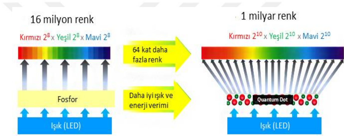
Şekil 2.20. Kuantum nokta yapı kullanılan ekranlar ile konvansiyonel ekran karşılaştırması [63]
