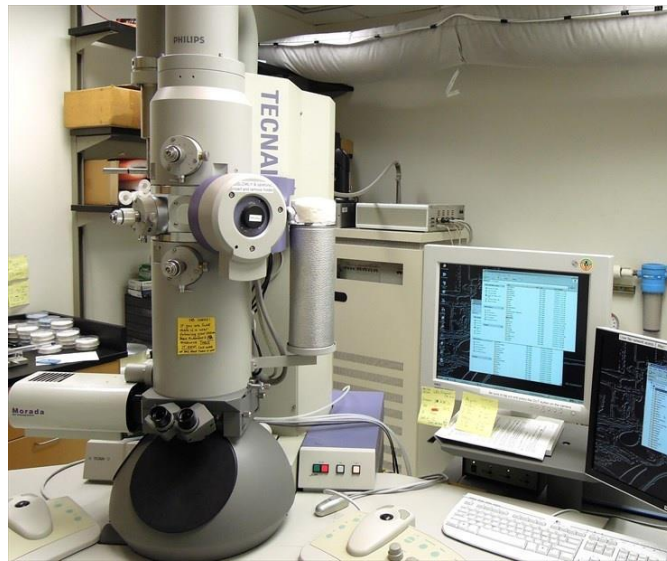
Şekil 3.6. ODTÜ Merlab'ta kullanılan CTEM Cihazı [96]
