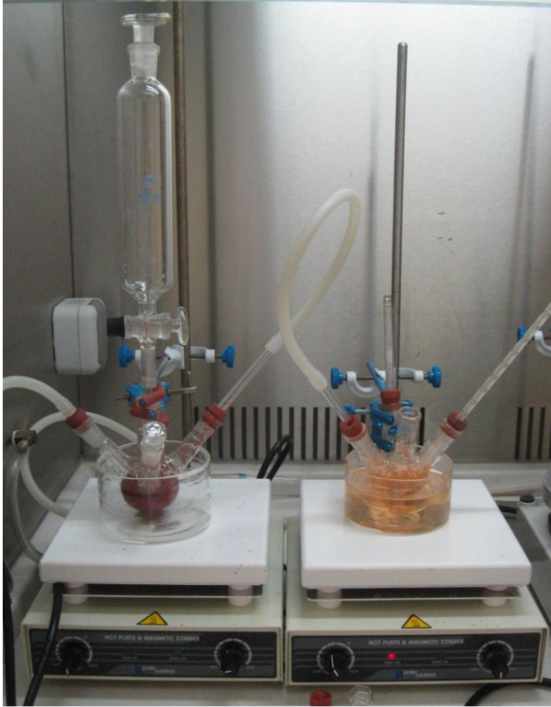
Resim 4.2. CdSe nanoparçacık çözeltisinin hazırlanmasında kurulan deney düzeneği
