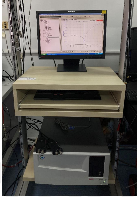
Görsel 7.1. KEITHLEY 4200-SCS/CVU elektriksel karakterizasyon sistemi
