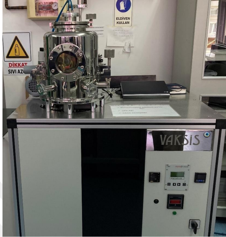
Görsel 3.7. VAKSIS marka fiziksel metal buharlaştırma sistemi
