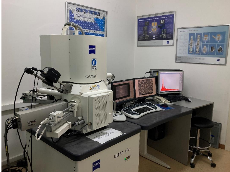
Görsel 6.2. ZEISS ULTRAPLUS marka taramalı elektron mikroskobu (SEM)
