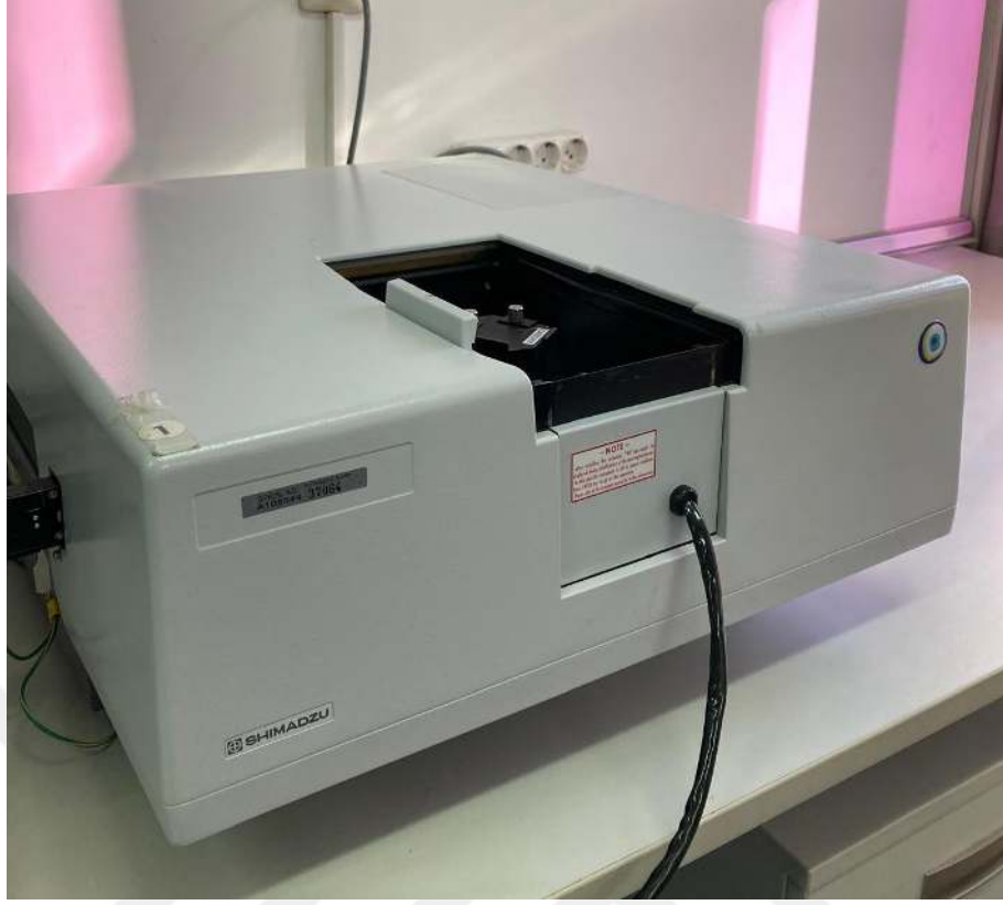
Görsel 5.1 Schimadzu marka UV 2450 model spektrofotometre cihazı
