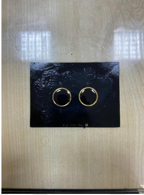
Şekil 3.13. Oda sıcaklığında bekleyen numuneler Şekil 3.14. Yumuşama Deneyi Cihazı
