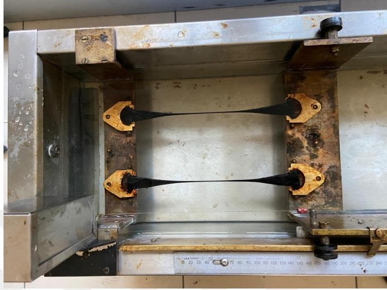
Şekil 3.17. Düktilite cihazına yerleştirilmiş numune
