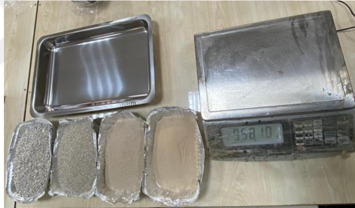
Şekil 3.20. Agrega karışımlarının hazırlanma aşaması
