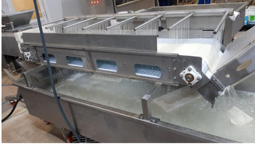
Şekil 3. 47.Kesme, Soğutma ve Tuzlama Makinası
