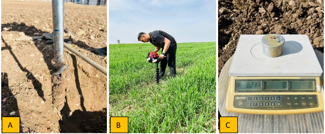
Şekil 3.7. Toprak örneği alınırken kullanılan aletler (A: spiral burgu; B: motorlu toprak burgu makinesi; C:dijital terazi ve örnekleme kabı)
