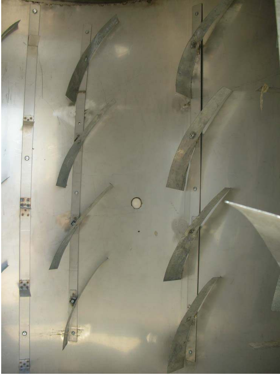
Şekil 7.2. Kurutma odası içerisine yerleştirilen hava yönlendirme elemanları
