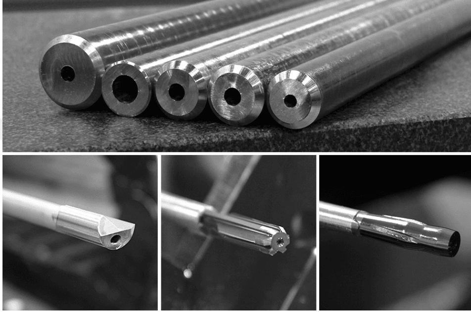
Şekil 2.20 Çekme yöntemiyle namlu üretiminde kullanılan takımlar ve işleme adımları (Unisig 2022).
