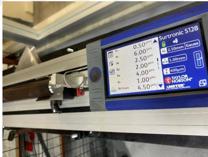
Şekil 3.4 Namlu 2-2'nin yüzey pürüzlülüğü ölçümü.
