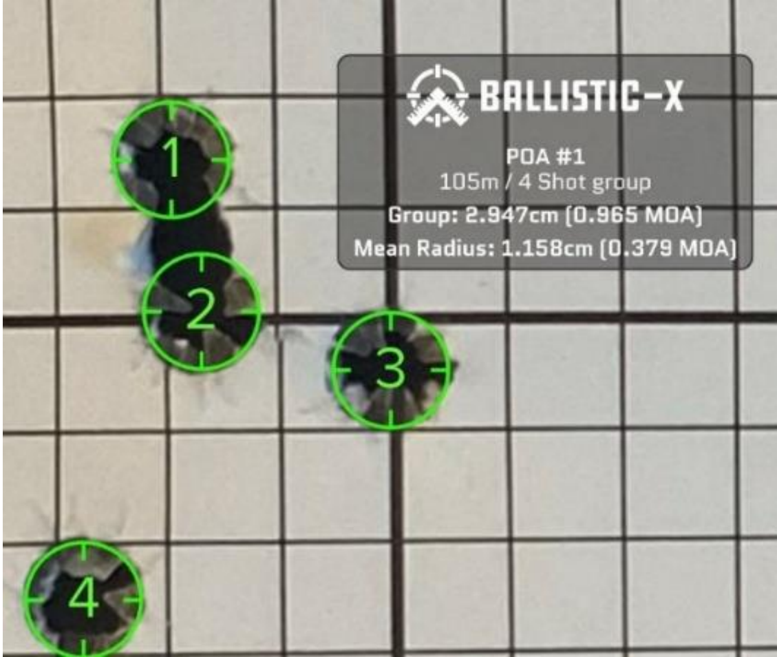
Şekil 3.6 105 metre mesafeye yapılan atışın hedef görüntüsü ve MOA analizi (Ballistic-X uygulaması ile elde edilmiştir).
