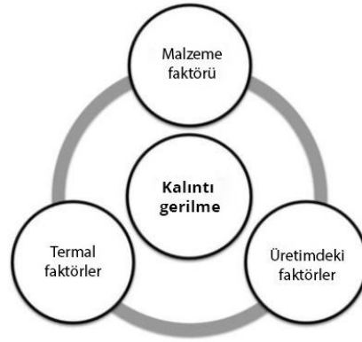
Şekil 2.21 Kalıntı gerilme oluşumunu etkileyen temel faktörler (Mishra vd. 2014).
