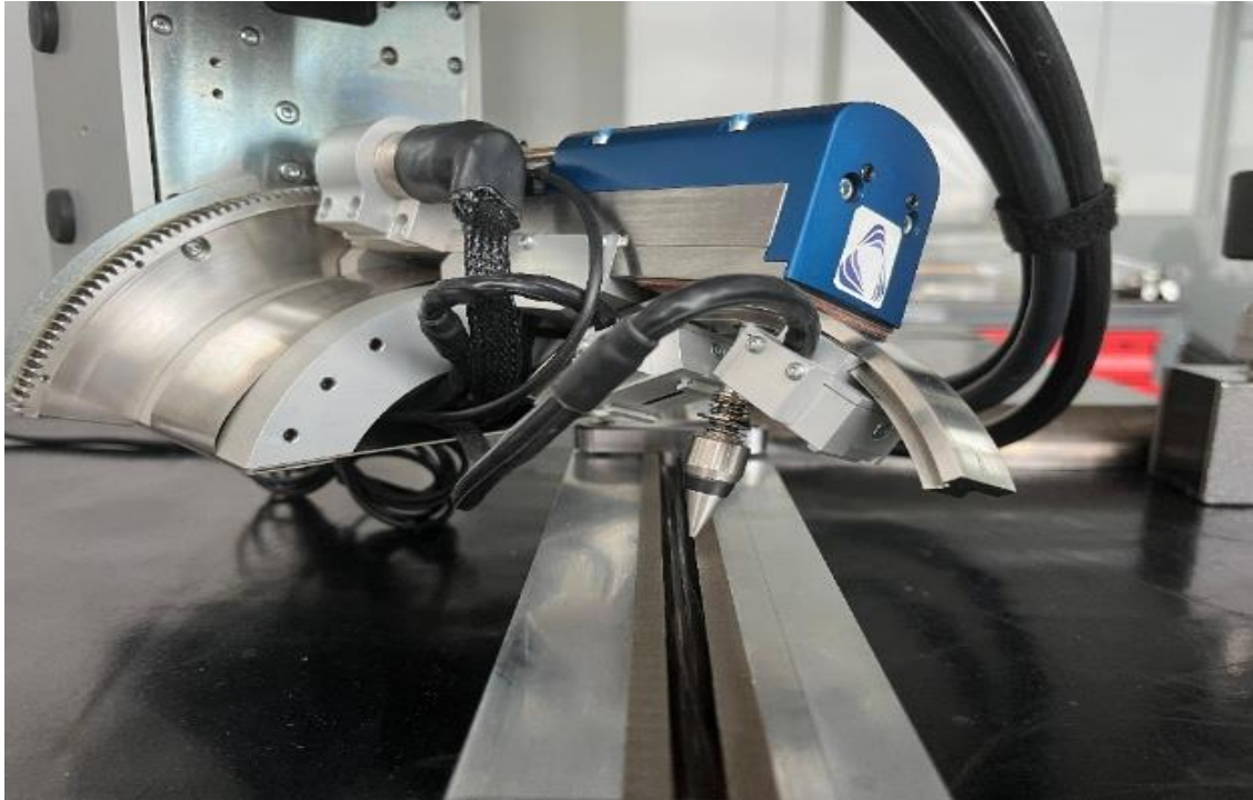
Şekil 3.5 Kalıntı gerilme ölçümünde kullanılan XRD cihazı ve namlu aparatı.
