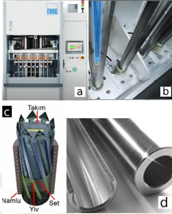
Şekil 2.19 a) Namlu üretimi için tasarlanan elektrokimyasal işleme tezgâhı, b) Aynı anda birden fazla namlunun tezgâhta işlenmesi, c) Elektrokimyasal işleme takımının şematik ifadesi, d) Namlu örneği (Emag 2025).
