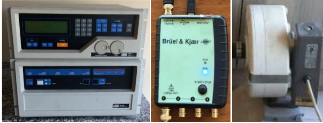
Şekil 3.13. Sırasıyla sinyal jeneratörü, titreşim analizörü ve soğutucu fan
