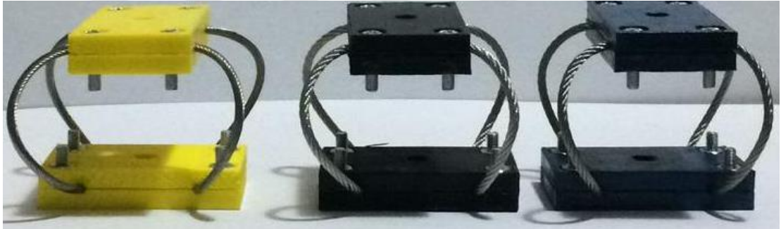
Şekil 2.15. ÇHTİ montajlanmış hali sırasıyla 7x7-1x19-7x19
