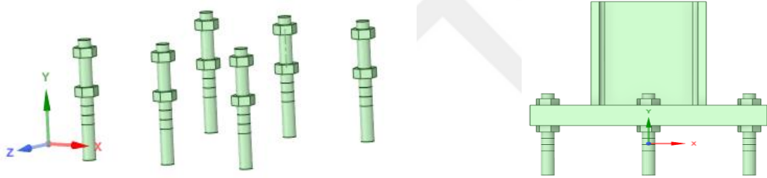
Şekil 5.11. Bulonların görünümüne ait kesit görünüşü (model-2)
