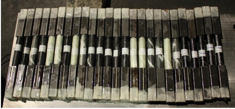
Şekil 4. 39. Burulma sonucu hasara uğramış numuneler
