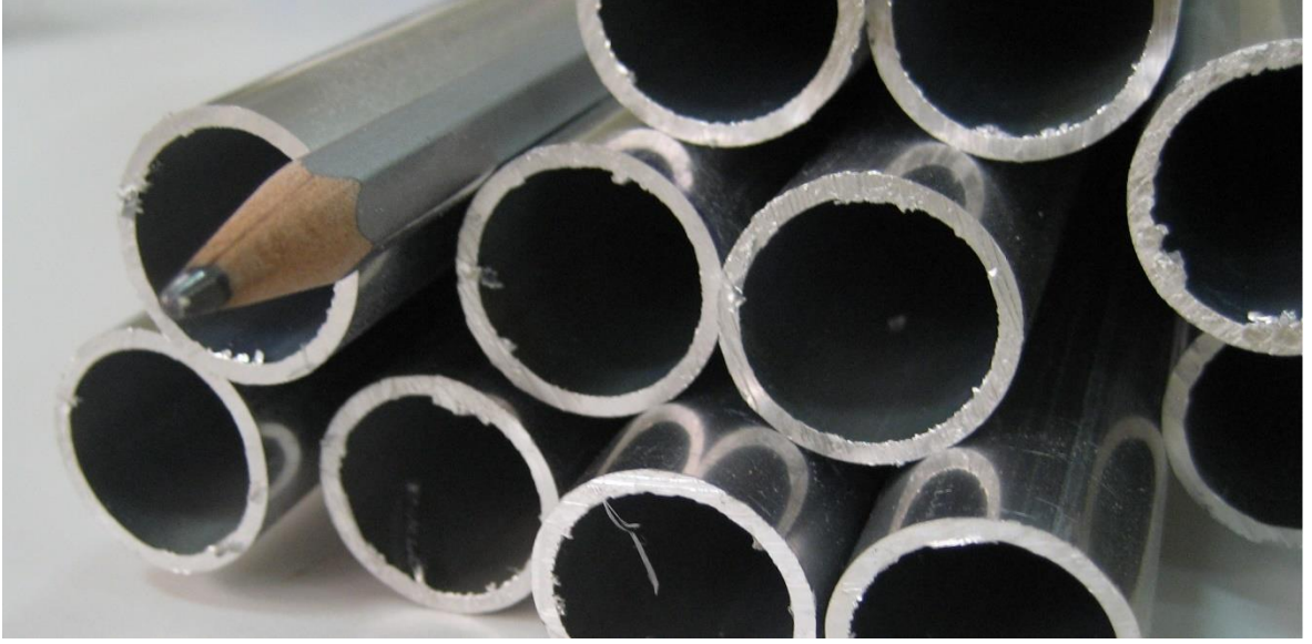
Şekil 4. 12. Şaft üretiminde kullanılan Al borular
