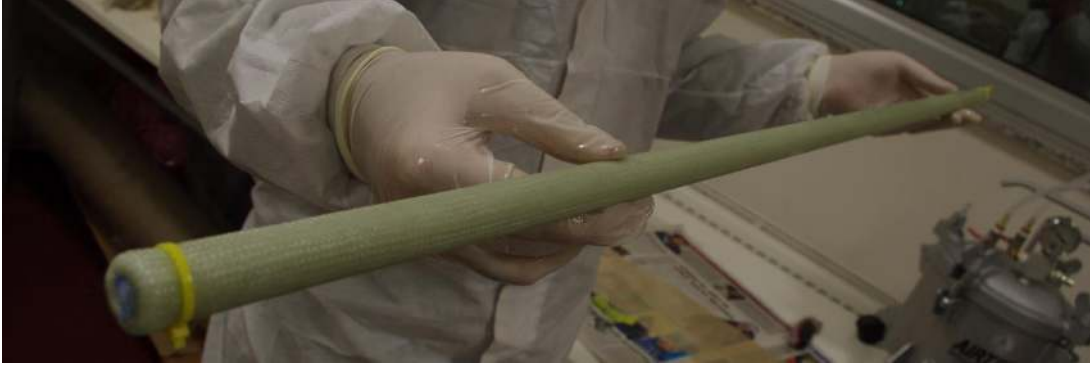
Şekil 4. 14. Vakum torbalama yöntemi ile üretilen şaft numunesi
