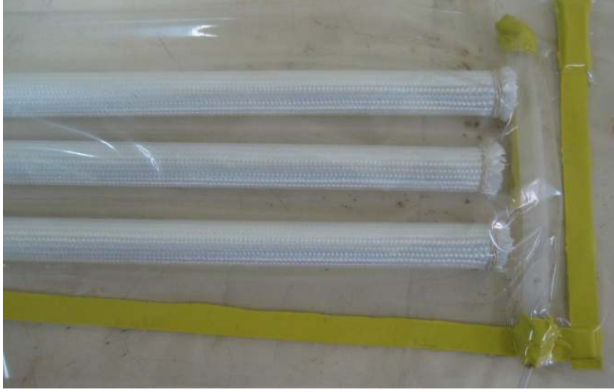
Şekil 4. 31. Paralel olarak yerleştirilmiş ve reçine dağıtımı için dağıtıcı kullanılmış VARTM modeli
