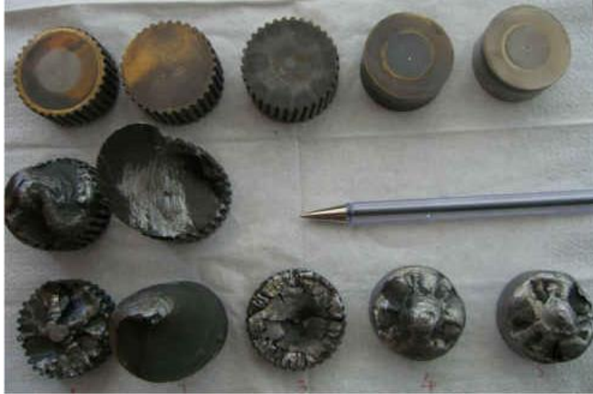
Şekil 3. 19. Hasara uğramış beş farklı milden hasar bölgesi görüntüleri ve hasara yakın bölgelerden çıkartılmış metalografi numuneleri
