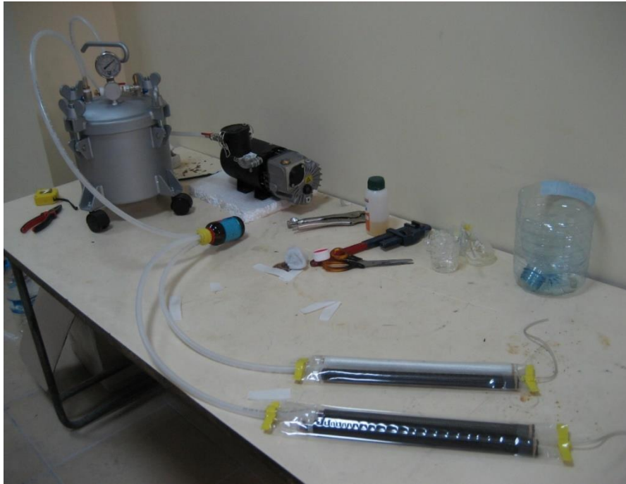
Şekil 4. 25. Vakumlanmış ortamda reçine beslemesi öncesi şaft numuneleri
