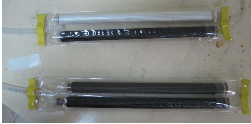
Şekil 4. 24. Vakumlanmış ortamda reçine beslemesi öncesi şaft numuneleri
