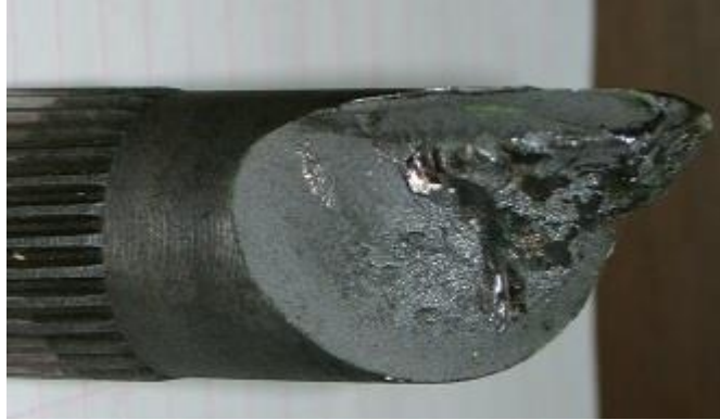
Şekil 2. 21. Milin dönme eksenini ile \approx 45^\circ 'lik açı yapan kırılma yüzeyi
