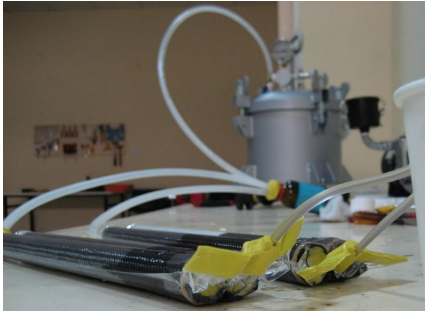
Şekil 4. 27. Vakum altındaki numunelere reçine beslemesinin yapılması
