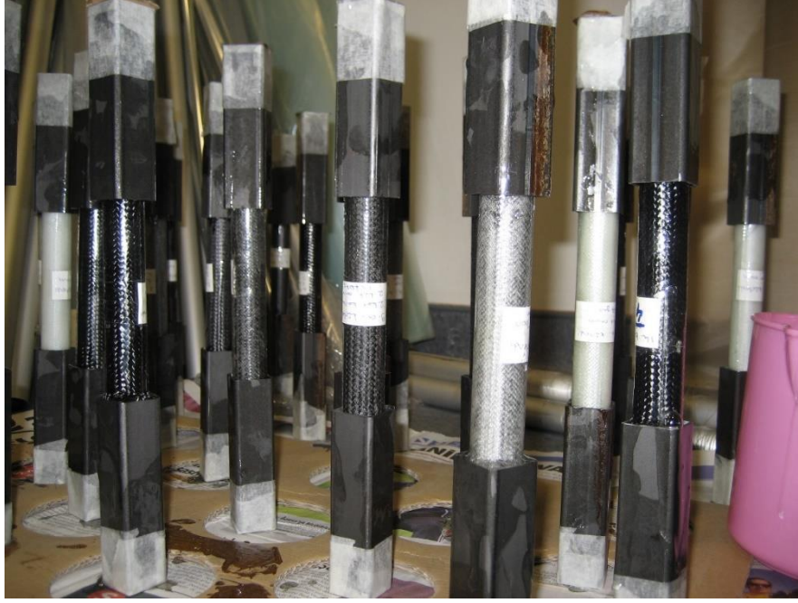
Şekil 4. 34. Tutucu uçların yapıştırıldığı, deneye hazır numuneler
