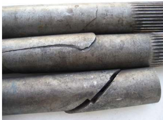
Şekil 3. 28. Dişsiz bölgeden hasara uğramış mil numuneleri
