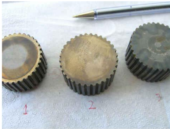
Şekil 3. 25. 1, 2 ve 3 numaralı numunelerin hasarlı bölgesindeki kırık görüntüsü
