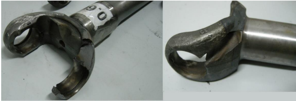
Şekil 3. 11. Çatalın uç kısmından hasara uğramış miller
