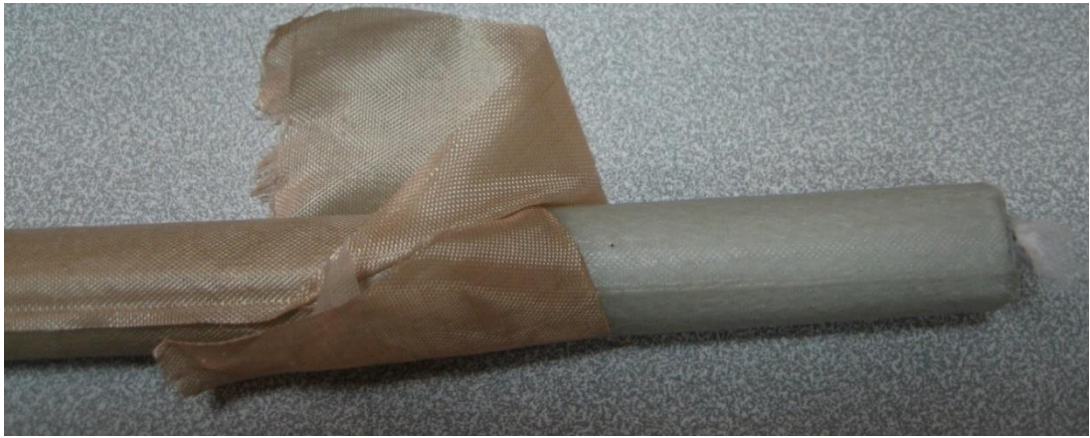
Şekil 4. 15. Soyma kâğıdına sarılmış numune
