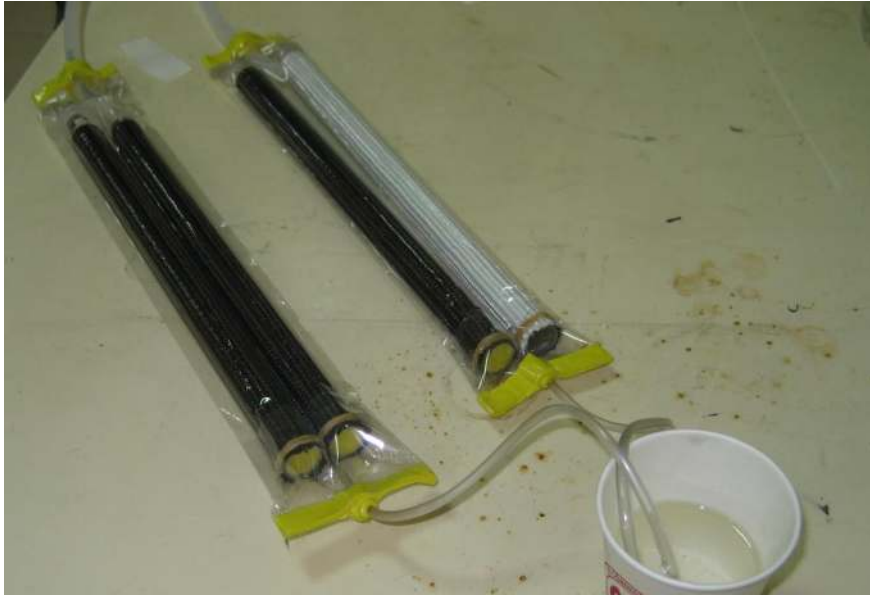
Şekil 4. 26. Vakum altındaki numunelere reçine beslemesinin yapılması
