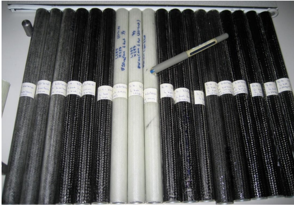
Şekil 4. 33. Boy ayarlaması yapılmış şaft numuneleri
