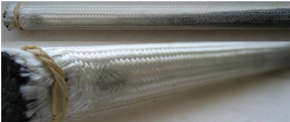
Şekil 4. 30. Reçinenin ilerleyememesi sonucu üretim problemi
