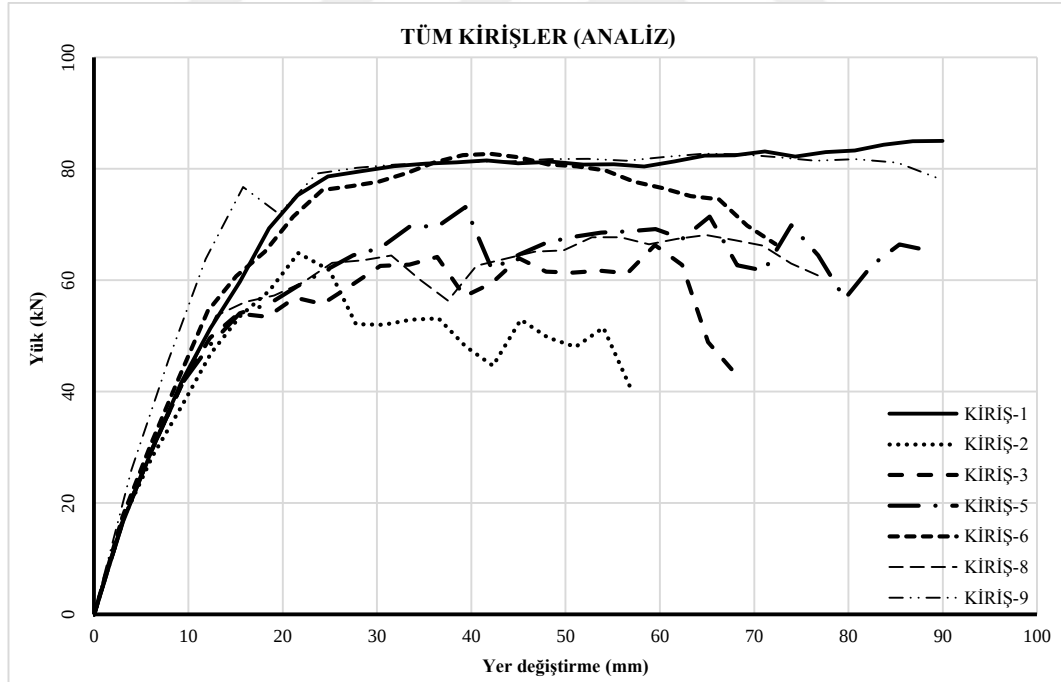
Şekil 5.9. Bu çalışmada elde edilen yük-yer değiştirme grafikleri
