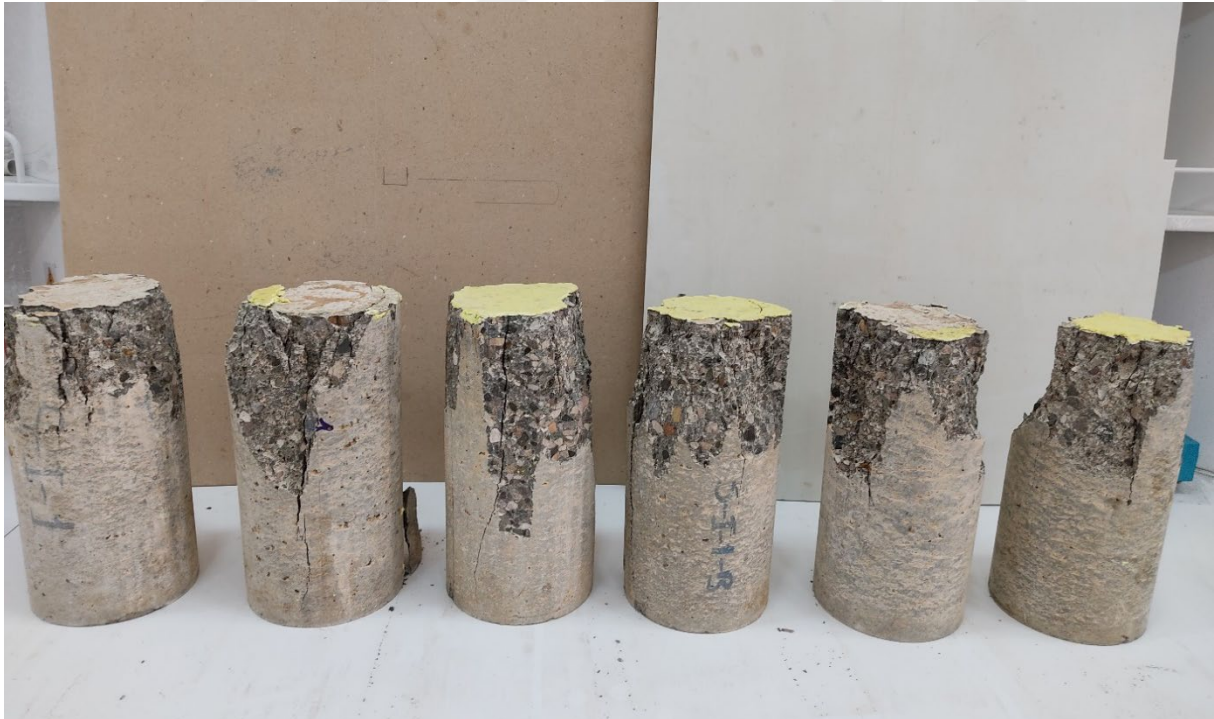
Şekil 3.8. Basınç deney testi uygulanmış silindir numuneler
