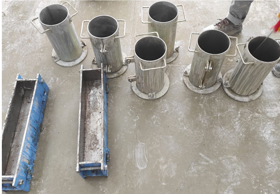
řekil 3.2. Silindir ve prizma numune kalıpları
