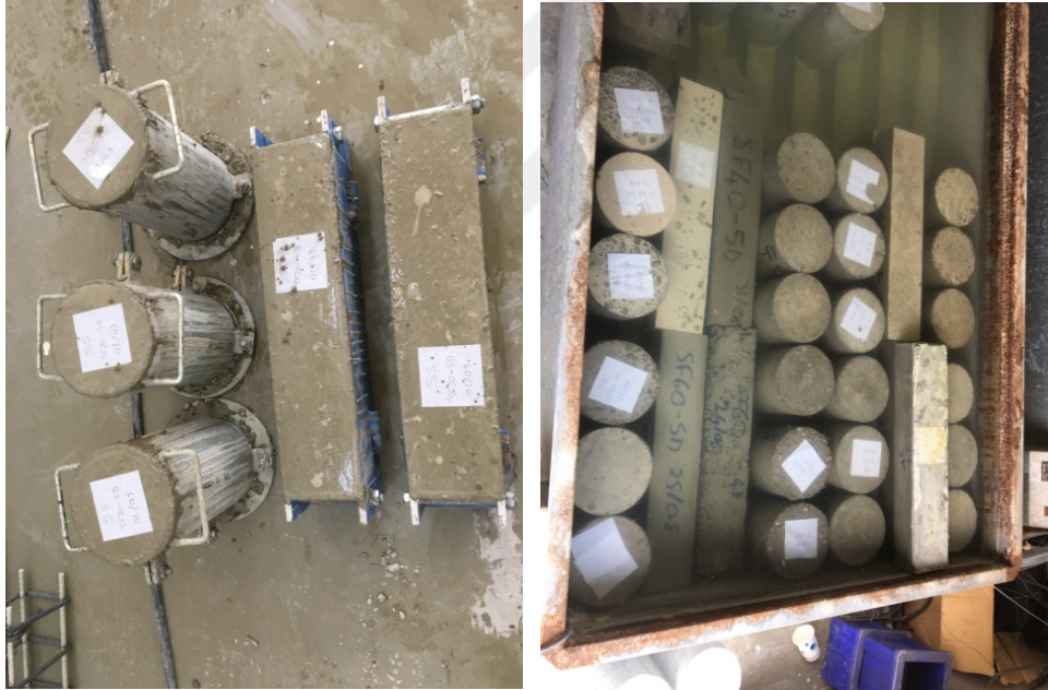
Şekil 3.7. Silindir ve prizma numune hazırlığı ve kür havuzuna bırakılması
