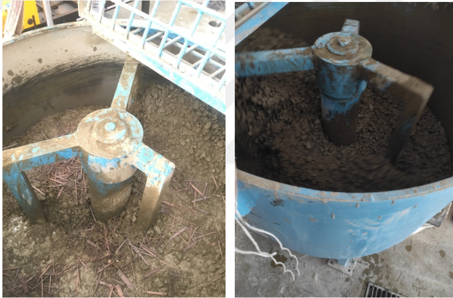
Şekil 3.5. Beton harcının hazırlanması
