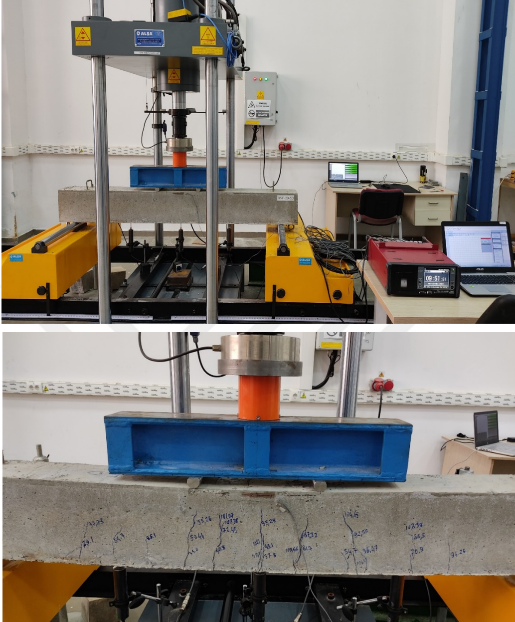
Şekil 3.21. Deney öncesi hazırlığı ve deney sonunda oluşan deformasyonlar
