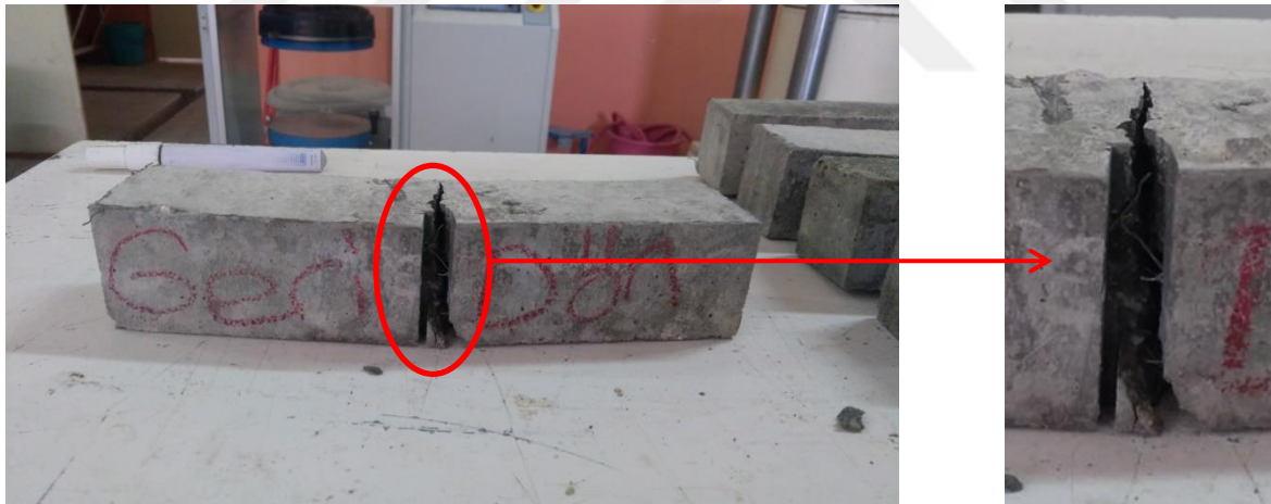
Şekil 6.5. Kırılma bölgesinde köprü görevi gören çelik lifler
