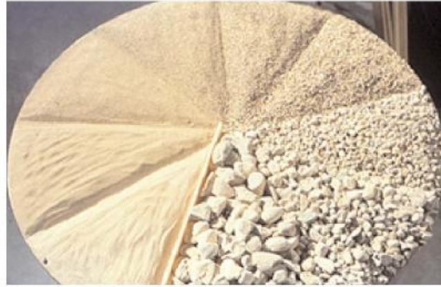
Şekil 3.1. Beton içerisinde kullanılan agregaların dane büyüklüğü dağılımları [22]
