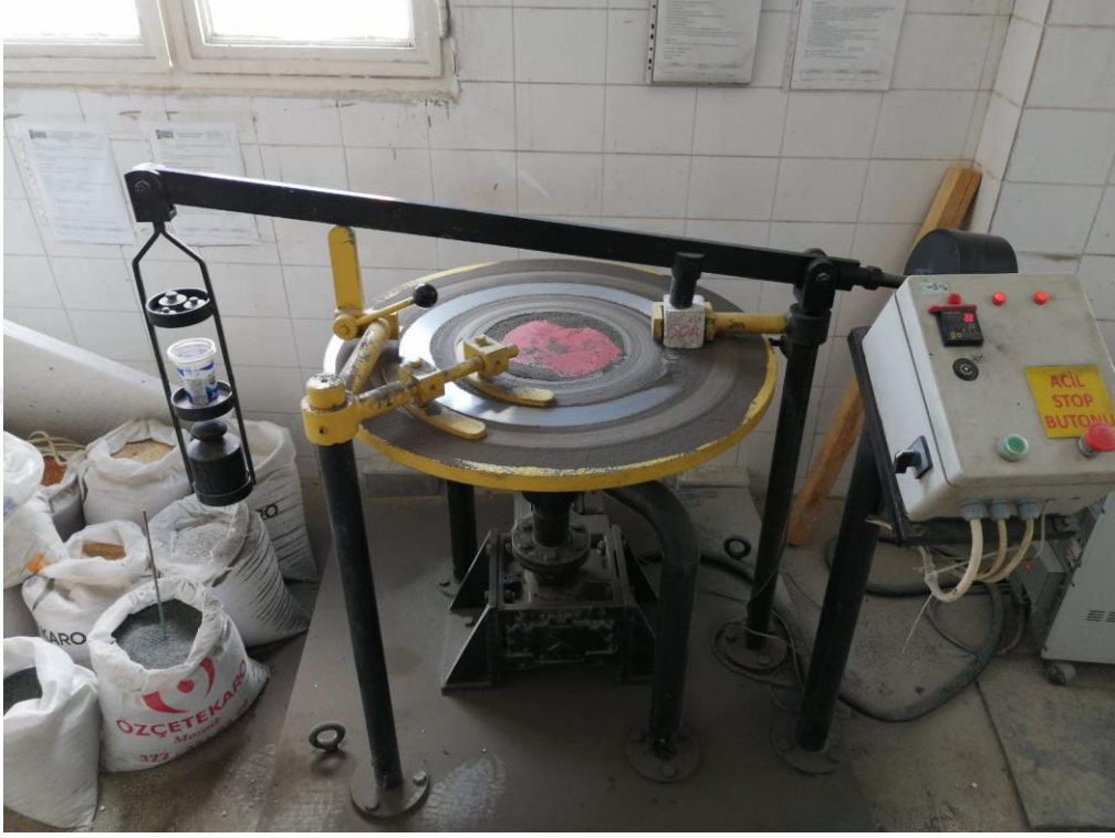
Şekil 6.7. Böhme deney cihazı ile aşınma dayanımı deneyinin uygulanması
