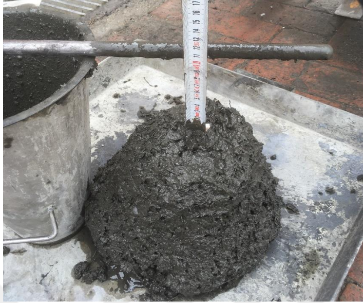
Şekil 3.9. Taze betonda çökme deneyi
