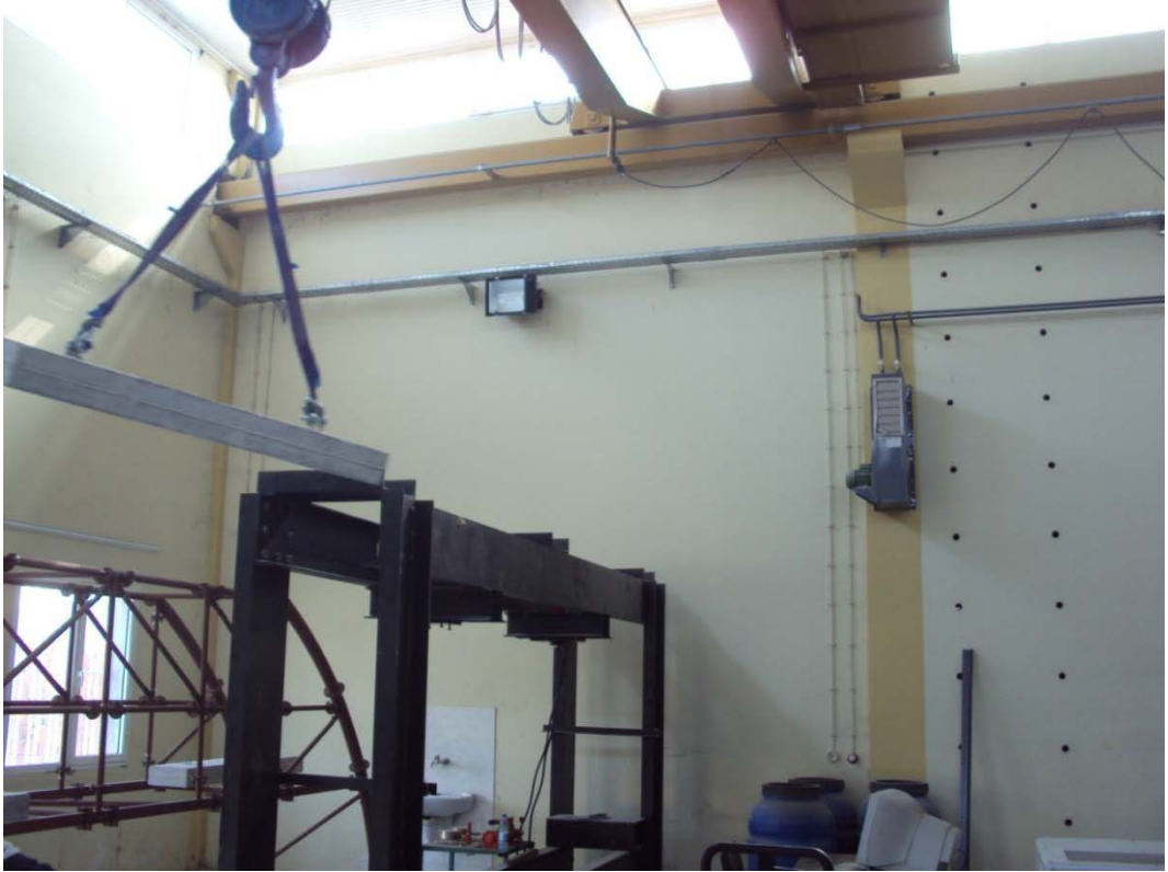
Şekil 8.16 Köprüye betonarme blok ağırlıkların yerleştirilmesi.
