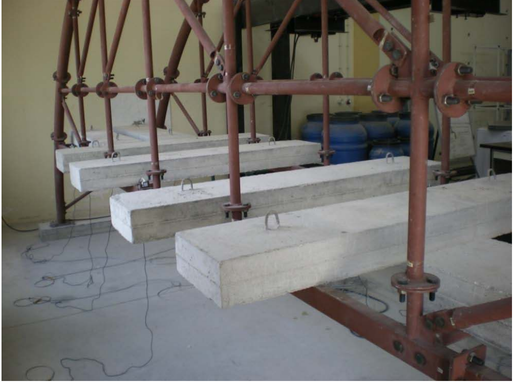
Şekil 8.17 Köprü üzerindeki betonarme ağırlıklar.
