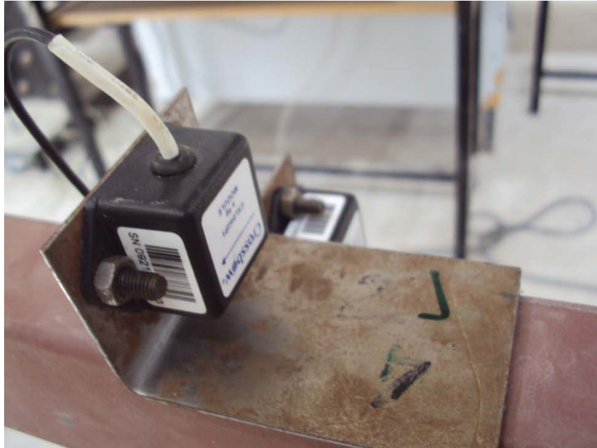
Şekil 8.15 Tek eksenli sensör.
