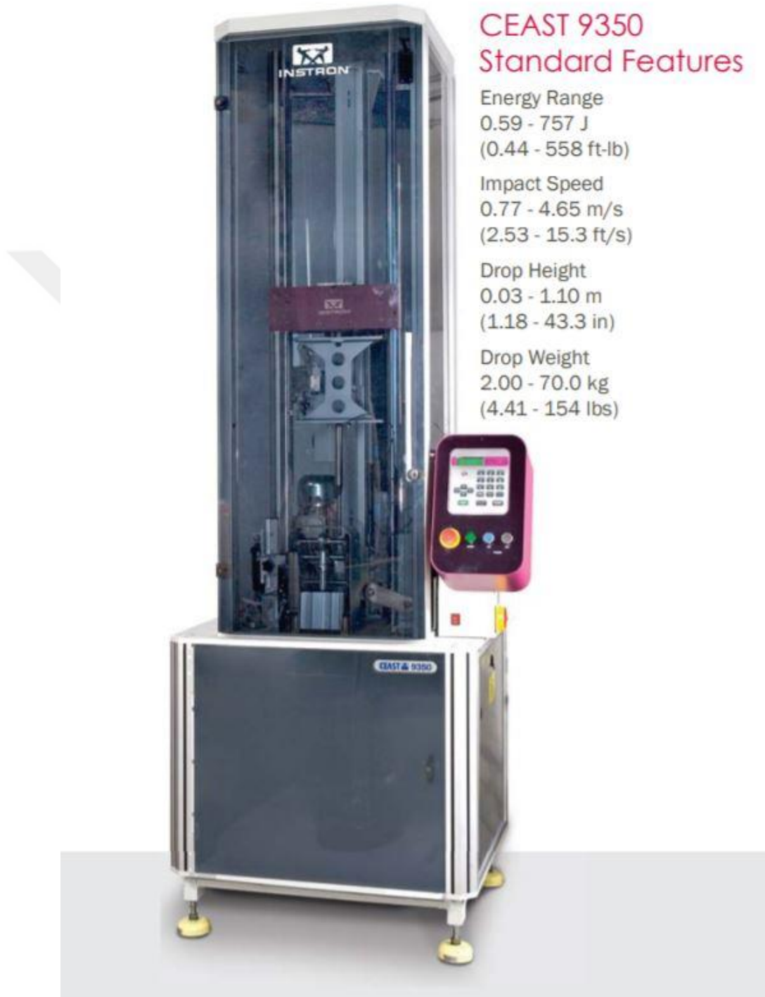
Resim 5.1 Deneyde kullanılan aletli ağırlık düşürme test cihazı [18]
