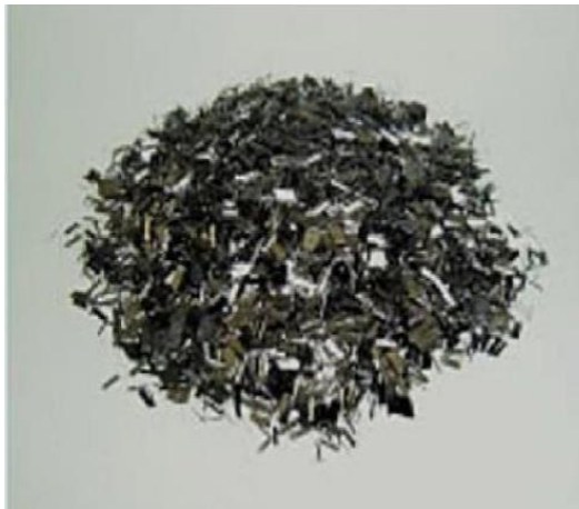
Şekil 3.9 Karbon liften kırılarak elde edilmiş elyaf [16]
