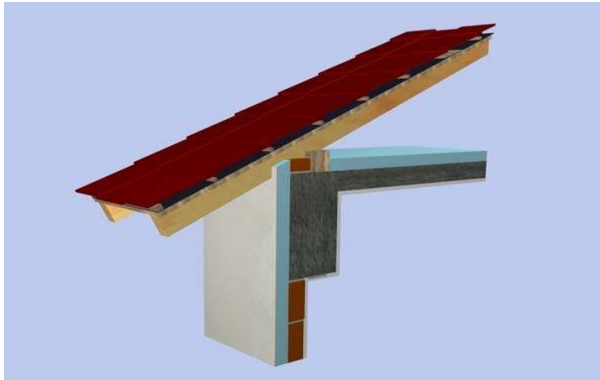
Şekil 4.16. Döşeme üstü ısı yalıtımlı çatı görünüşü [20]
