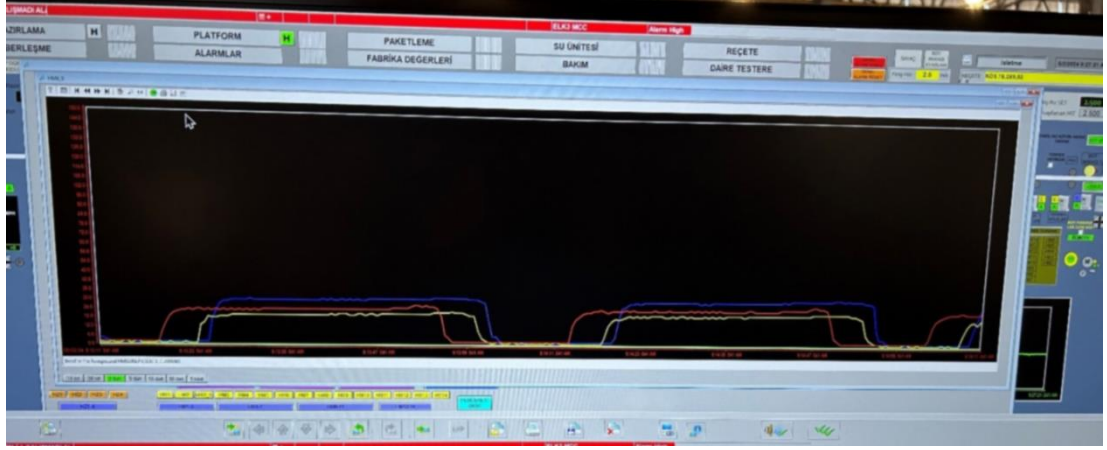
Şekil 4.13. Üretim tezgahları akım değişim grafiği ekranı.
