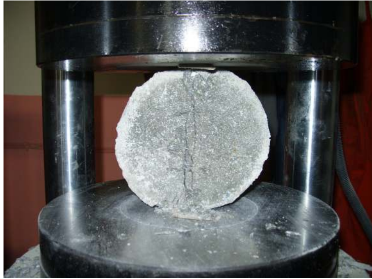
Şekil 3.6. Yarmada çekme dayanımı deney düzeneği
