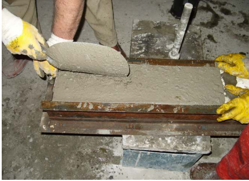
Şekil 3.2. Kiriş beton numunesi vibratöre maruz durumda
